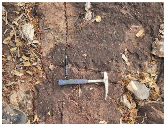
Figura 13 - Afloramento de quartzito maciço, de coloração rósea, com duas direções de fraturamento.
