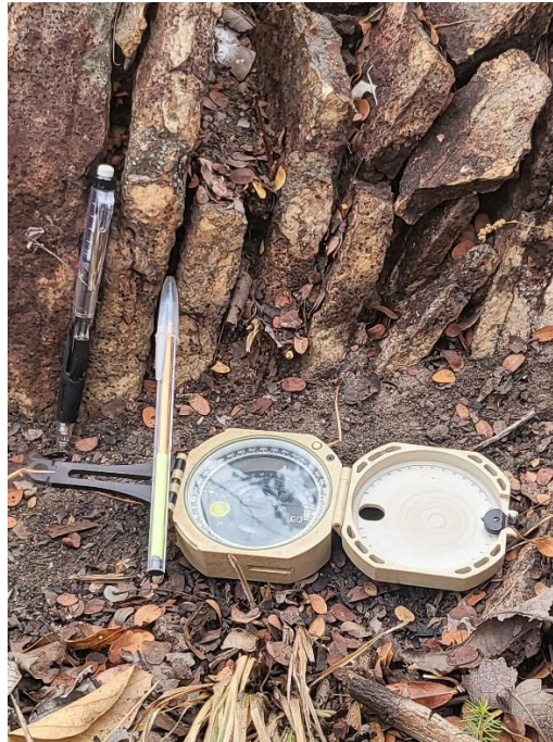
Figura 16 - Quartzito branco à cinza muito fraturado (cisalhado). Direção de acamamento N60E e mergulho de 70NW
