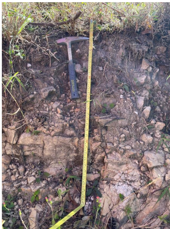
Figura 49 – perfil de solo cambissolo na área de estudo com profundidade de ~50 cm.
