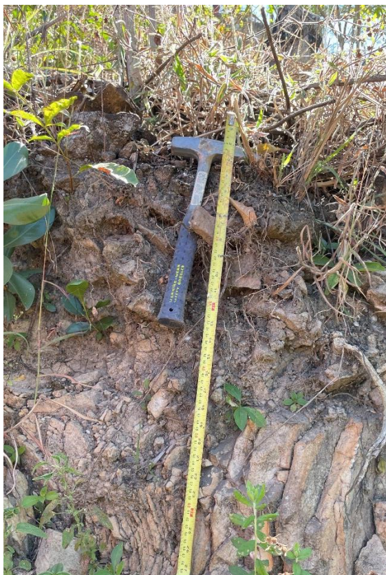
Figura 48 – Perfil de solo cambissolo na área de estudo com profundidade de ~ 45 cm.
