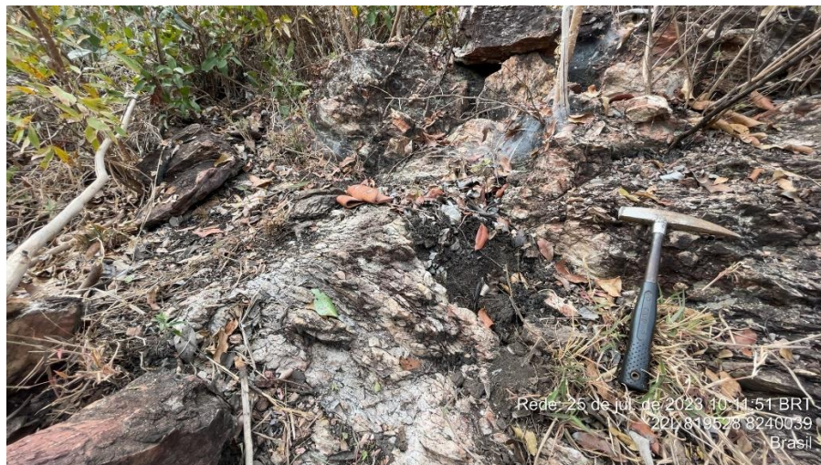
Figura 14 - Aspecto de quartzito branco à cinza muito fraturado.
