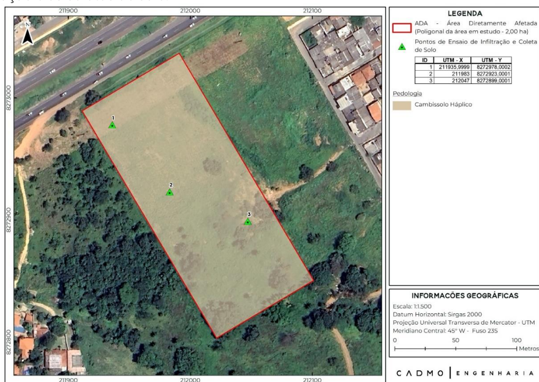
Figura 54 - Mapa de localização dos pontos onde foram realizados os ensaios de infiltração e as coletas de solo.
