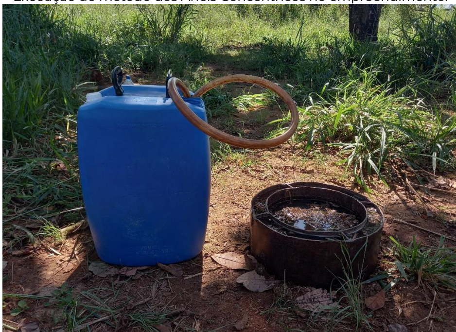
Figura 55 - Execução do método dos Anéis Concêntricos no empreendimento.
