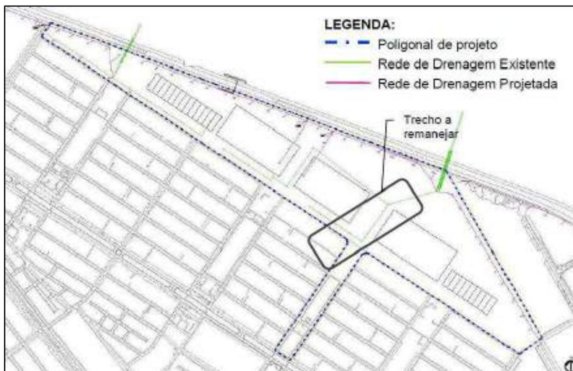
**Figura 75:** Croqui de interferências de drenagem.
