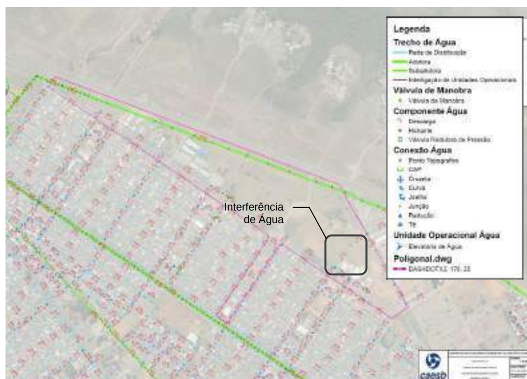
Figura 10: Croqui de interferências de redes de água
