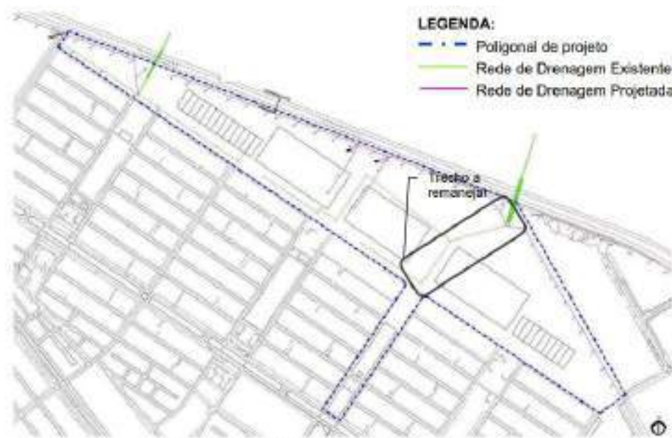
Figura 20 – Croqui de interferências de drenagem Fonte: NUARO/GEPRO/DITEC/TERRACAP
