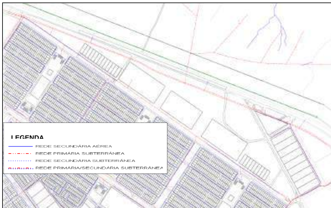
Figura 8: Croqui de interferências de redes elétricas
