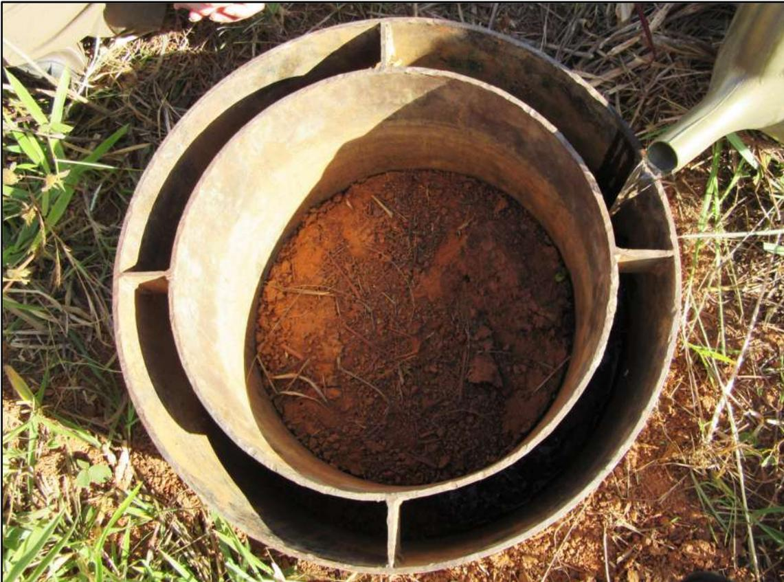
Foto 23: Rebaixamento do nível da água no cilindro interno.
