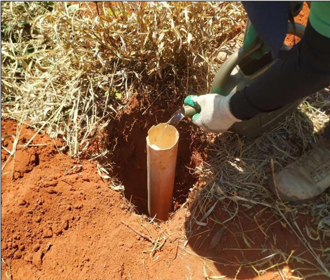
Foto 24: Preenchimento do cano PVC com água para posterior medição da altura do nível d'água.
