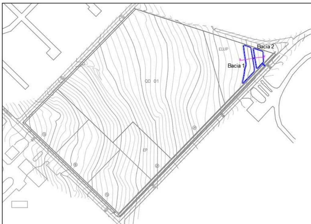
Figura 106: Sistema de drenagem pluvial – localização das bacias de retenção.
