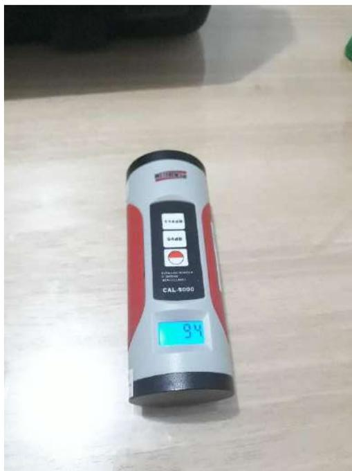
Figura 31: Foto do calibrador acústico utilizado no levantamento de campo.
