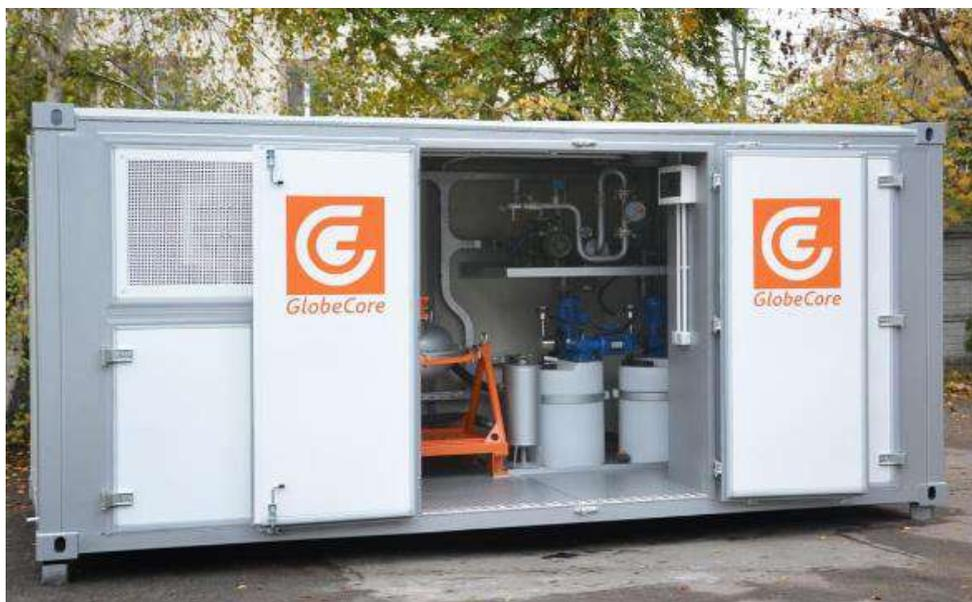
Figura 99: Modelo de contêiner com UTS.
