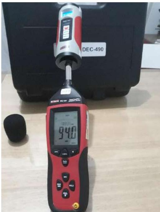
Figura 30: Foto do medidor de nível de pressão sonora utilizado no levantamento de campo mostrando que está calibrado.
