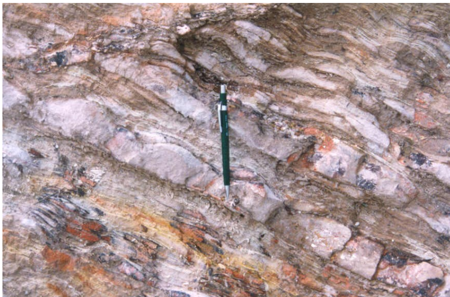
Foto 14- Detalhe da exposição típica do metarritmito R 3 no DF. Notar as camadas de base plana e topo ondulado e as lentes arenosas.
