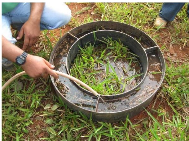
Figura 38 – Enchimento dos anéis concêntricos.
