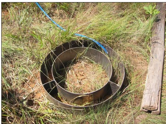
Figura 28 – Método dos Anéis Concêntricos.
