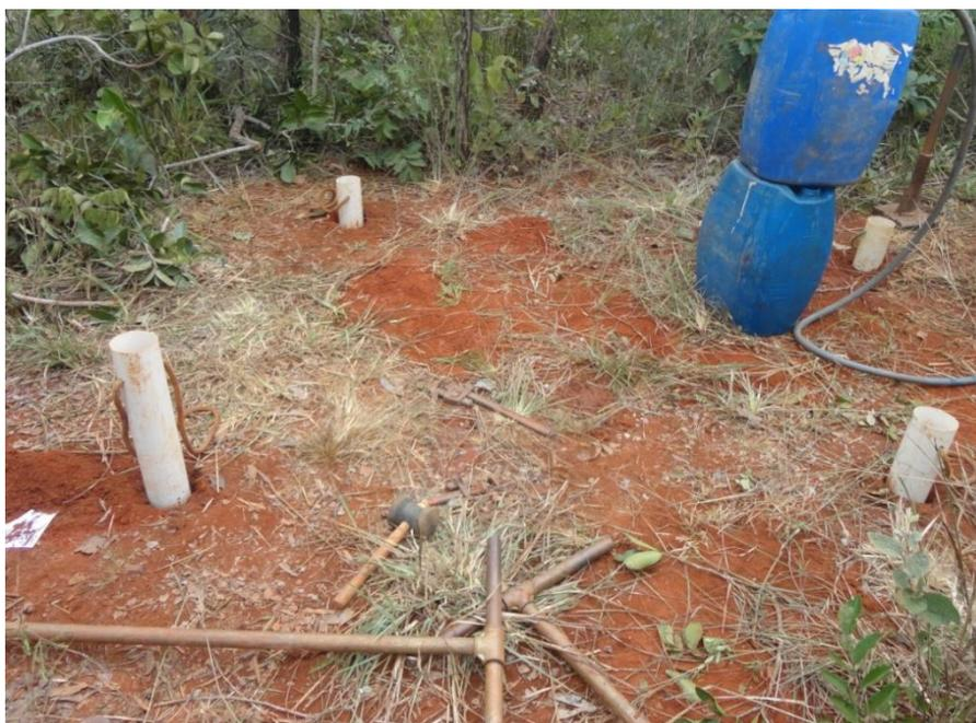
Figura 37 - Realização dos testes de infiltração.
