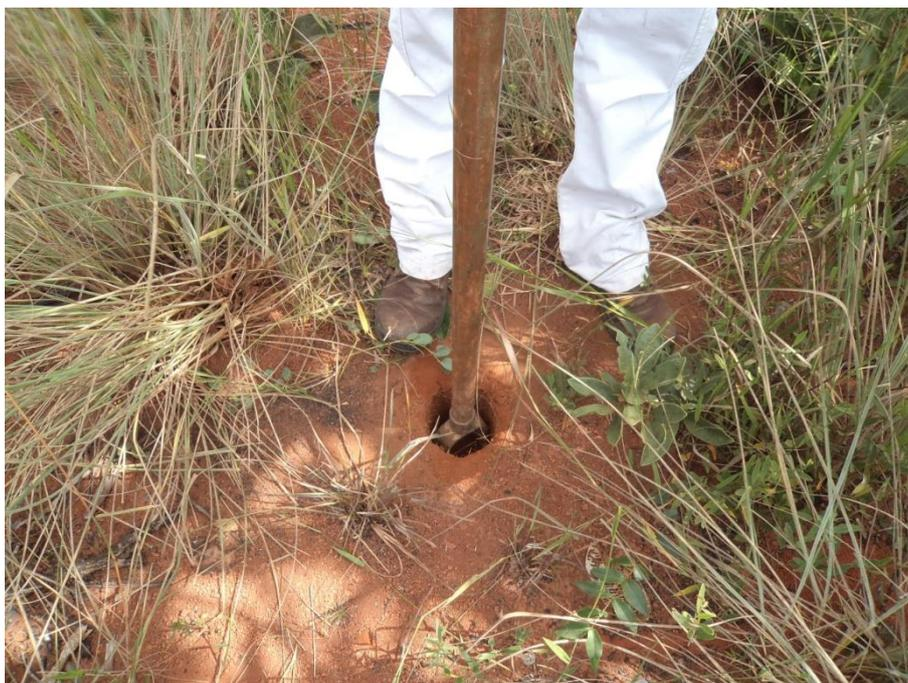
Figura 20 - Coleta de solo por tradagem em um dos pontos amostrados.
