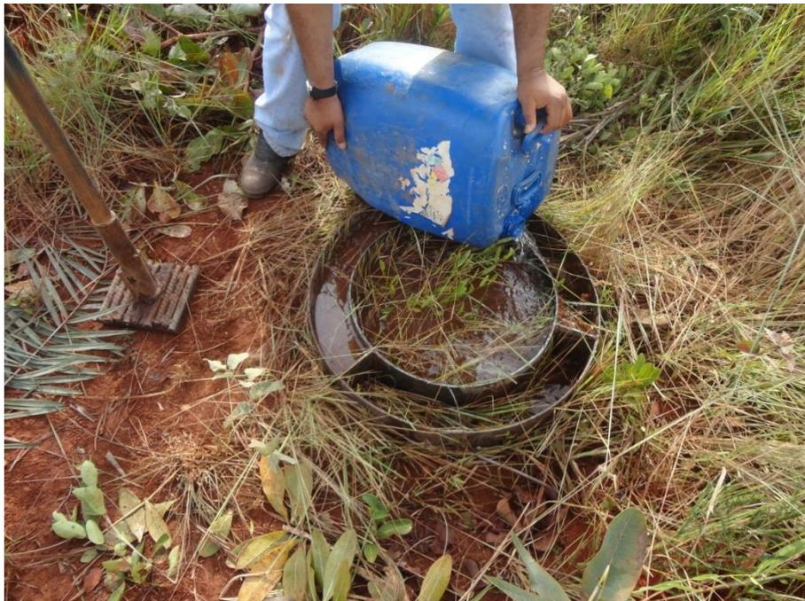
Figura 31 - Realização do teste de infiltração no ponto de amostragem. Método dos anéis concêntricos.
