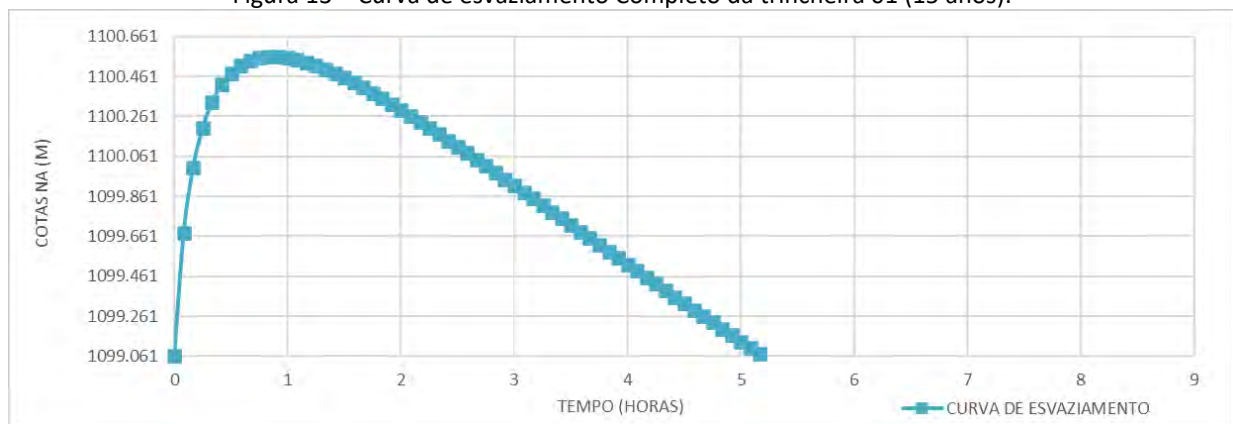
Figura 13 – Curva de esvaziamento Completo da trincheira 01 (15 anos).
