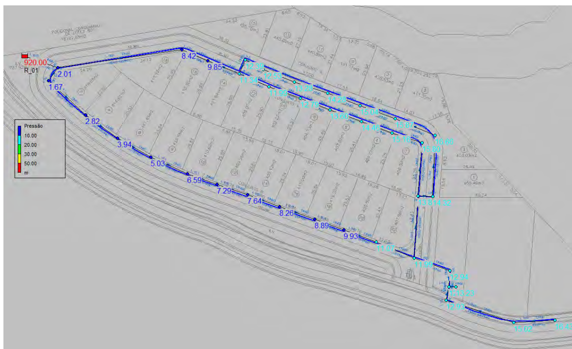
Figura 6.4: Resultados de pressões estáticas ao longo da rede projetada, considerando vazão mínima.
