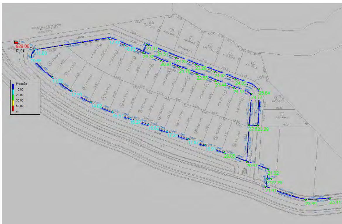
Figura 6.3: Resultados de pressões dinâmicas ao longo da rede projetada, considerando vazão máxima horária.
