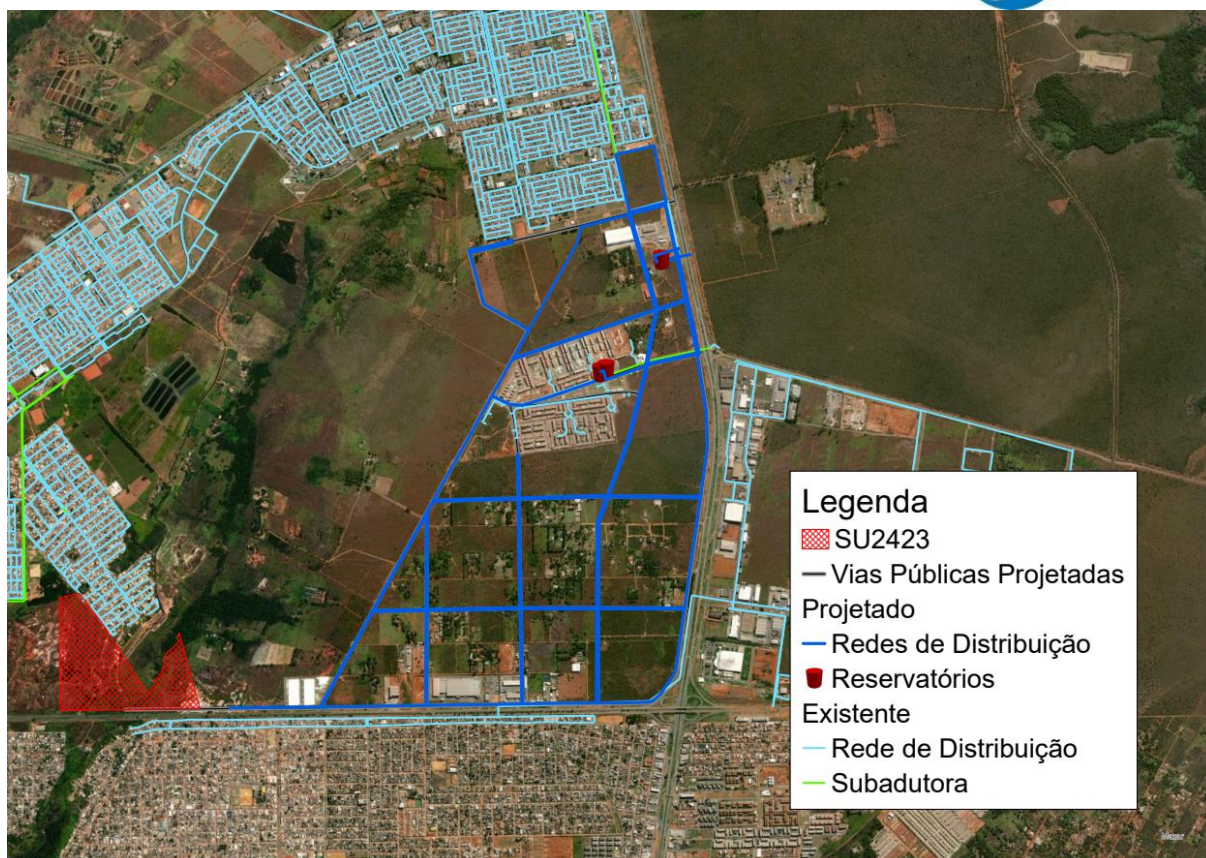
Figura 2. Sistema Projetado de Abastecimento de Água
