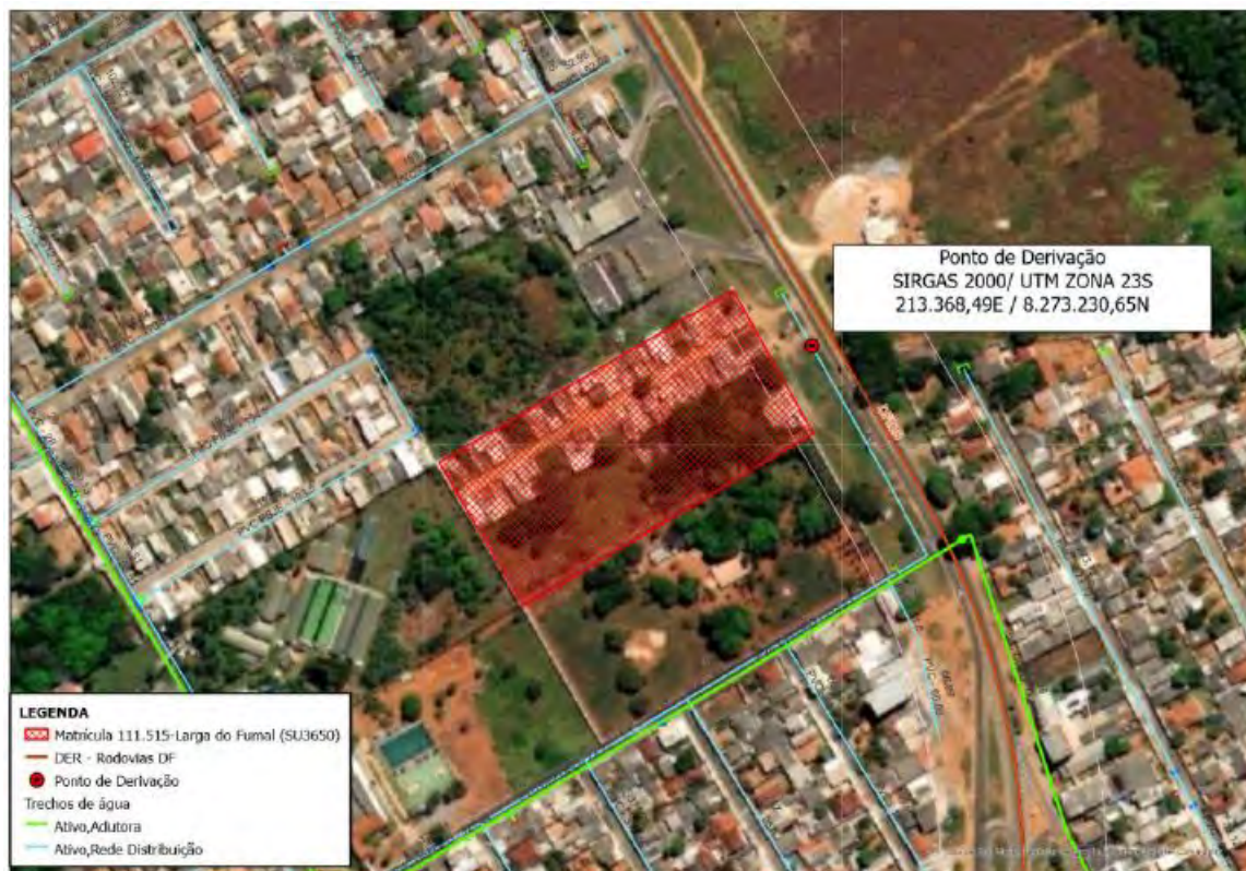
Figura 45: Ponto de derivação do SAA para interligação.
