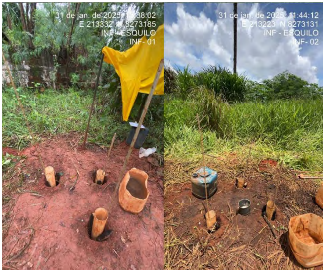
Foto 8: Execução dos ensaios de infiltração na Área Diretamente Afetada – ADA.
