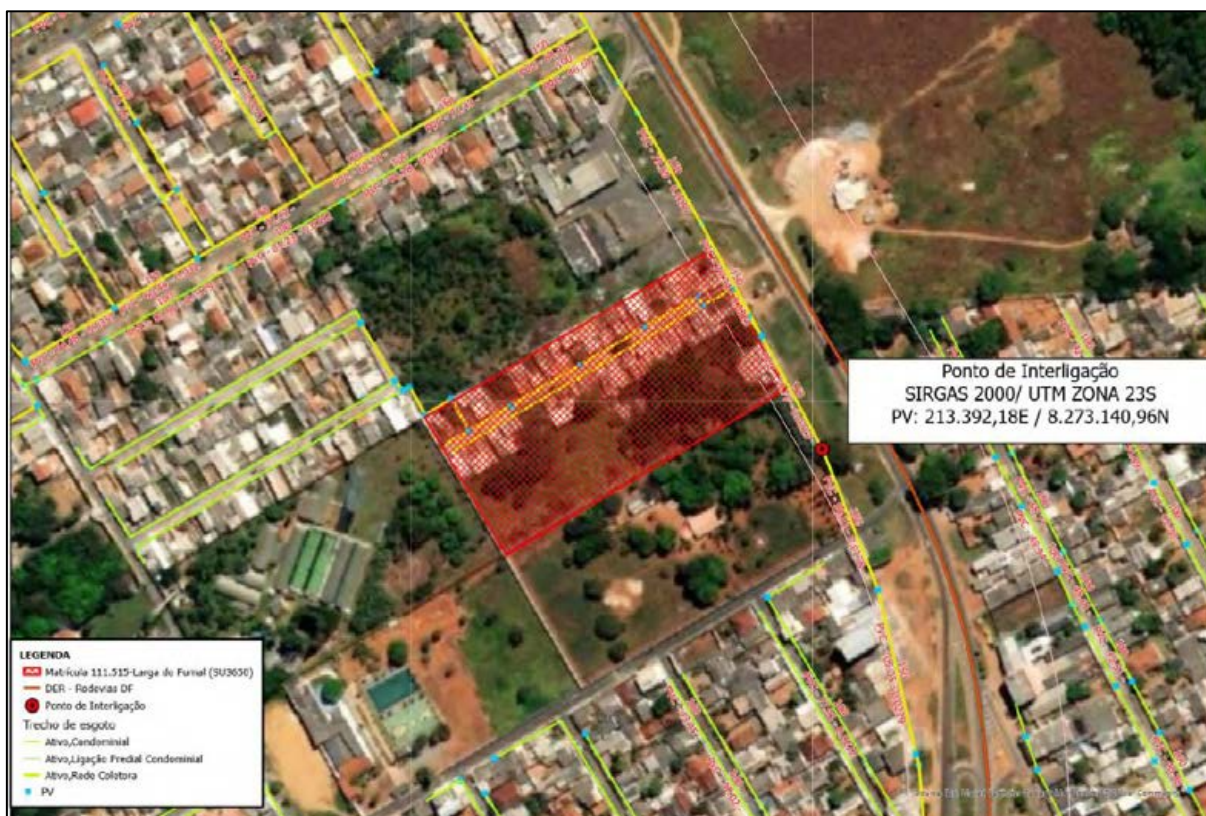
Figura 127: Ponto de interligação para esgoto.
