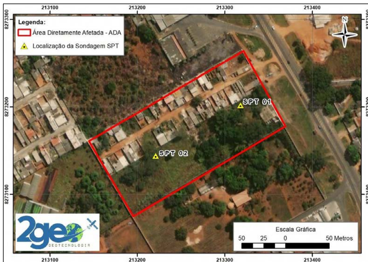
Figura 54: Localização dos ensaios SPT.
