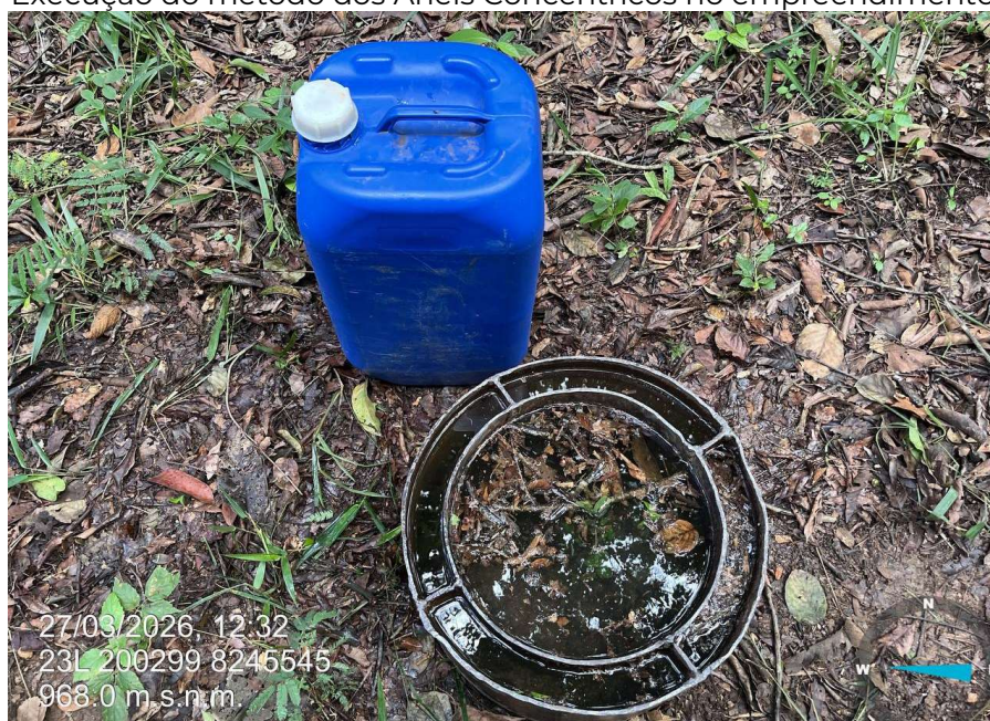
Figura 64 - Execução do método dos Anéis Concêntricos no empreendimento.
