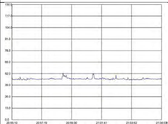
Figura 15: Gráfico gerado pelo decibelímetro com a função Data Logger para o ponto analisado no período Noturno ponto 03.
