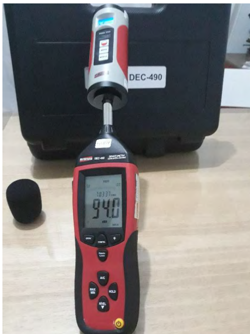
Figura 1: Foto do medidor de nível de pressão sonora utilizado no levantamento de campo mostrando que está calibrado.
