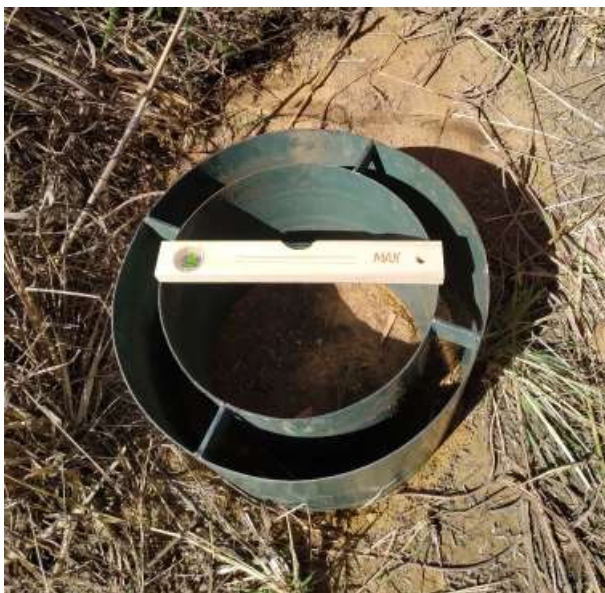
Figura 28 – Nivelamento do equipamento para início do procedimento. Localização: 811.033 E / 8.245.864 S.
