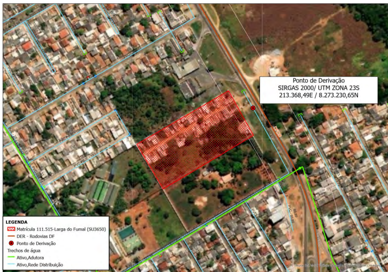
Figura 08: Ponto de derivação abastecimento de água Fonte: TVT nº 003/2023
