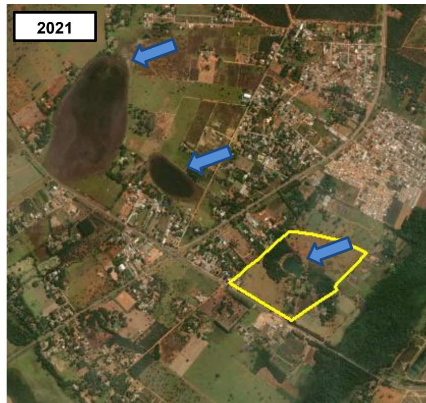
Figura 22. Imagem da região do empreendimento com afloramento de água subterrânea no ano de 2021. Fonte: Geoportal (2023).
