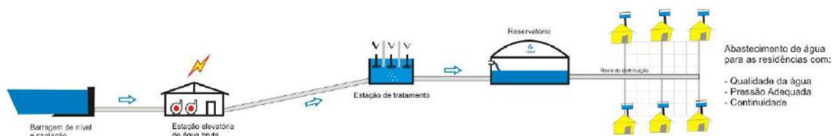
Figura 126 – Exemplo de configuração de sistema convencional. Fonte: CAESB, 2008a.
