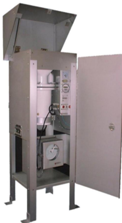
Figura 3 . Amostrador de grandes volumes para para determinação da concentração de material particulado total: AGV-PTS.
