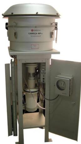
**Figura 4 .** Amostrador de grandes volumes para para determinação da concentração de material particulado inalável PM10: AGV-PM10.
