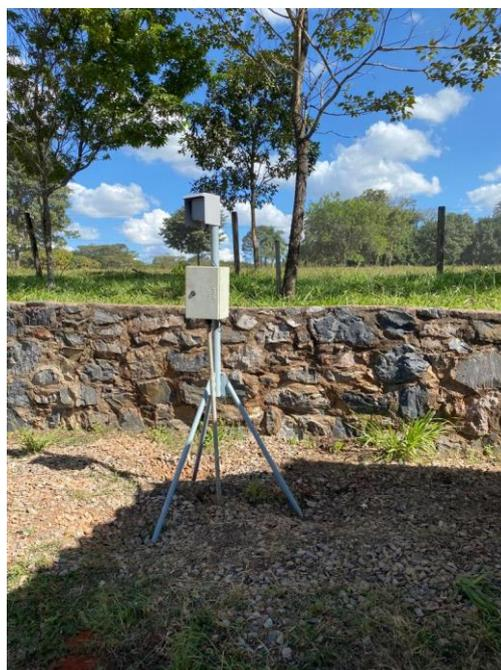
**Figura 1** – Equipamento instalado para monitoramento da qualidade do ar, no empreendimento Pedreiras Contagem.
