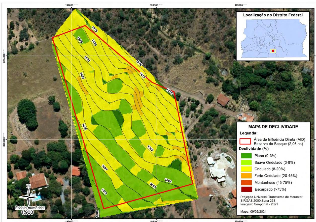
Figura 35 - Mapa de Declividade com base nas curvas de nível do levantamento topográfico cadastral. Fonte: TT Engenharia, 2024.
