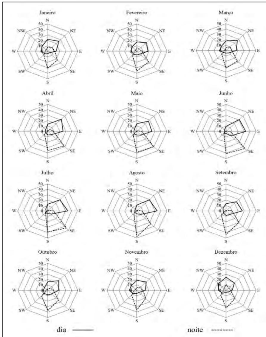
Figura 57 - Frequência de direção do vento diurno e noturno para todos os meses do ano, durante o período de 2000 a 2010. Fazenda Água Limpa – UnB. Fonte: Maggiotto. Et. Al., 2013.
