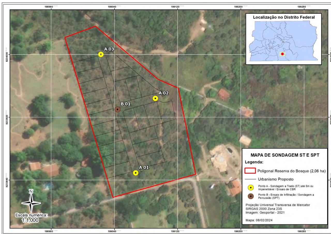
Figura 37 – Mapa dos pontos de sondagem a trado e SPT executados. Fonte: Autor.
