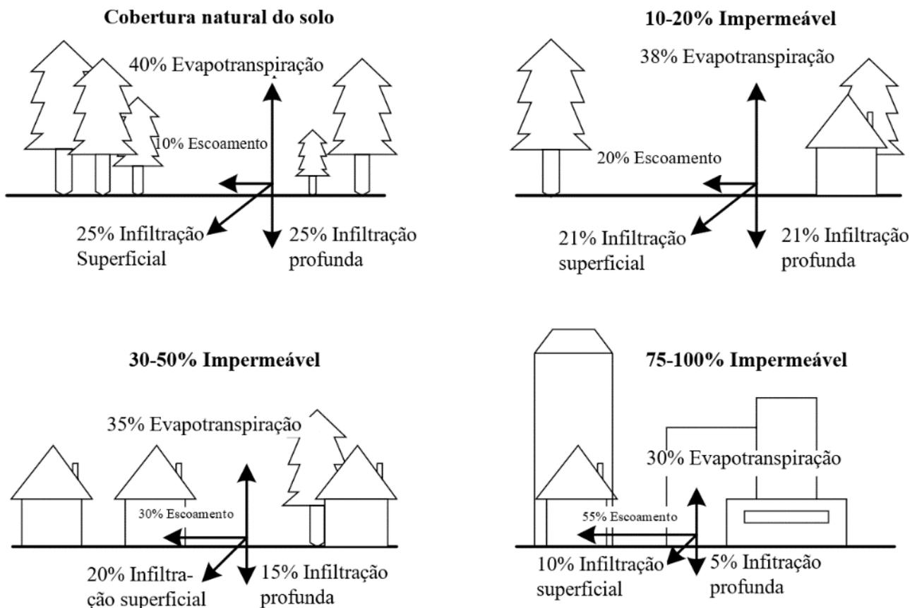
Figura 86 - Efeitos da impermeabilização sobre o escoamento superficial e infiltração. Fonte: Adaptado de Karamouz et al. (2010).
