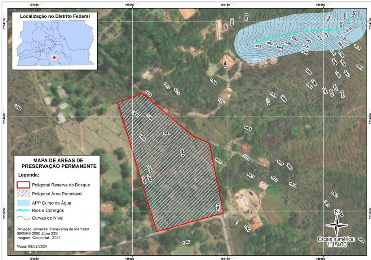
Figura 47 – Ausência de APPs sobrepostas a gleba – interpretação das curvas de nível da topografia e vistorias em campo. Fonte: TT Engenharia, 2024.
