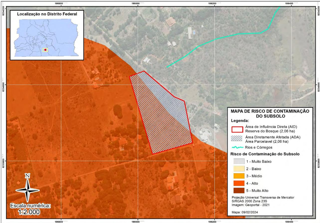
Figura 18 – Mapa de risco de Contaminação do Subsolo
