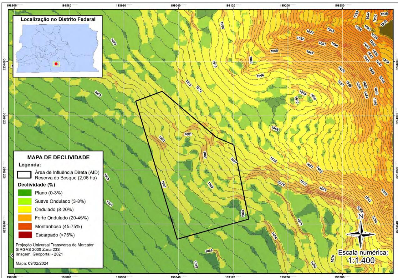
Figura 34 - Mapa de Declividade com base nas curvas de nível do Geoportail. Fonte: Geoportail DF, adaptado pela TT Engenharia, 2024.
