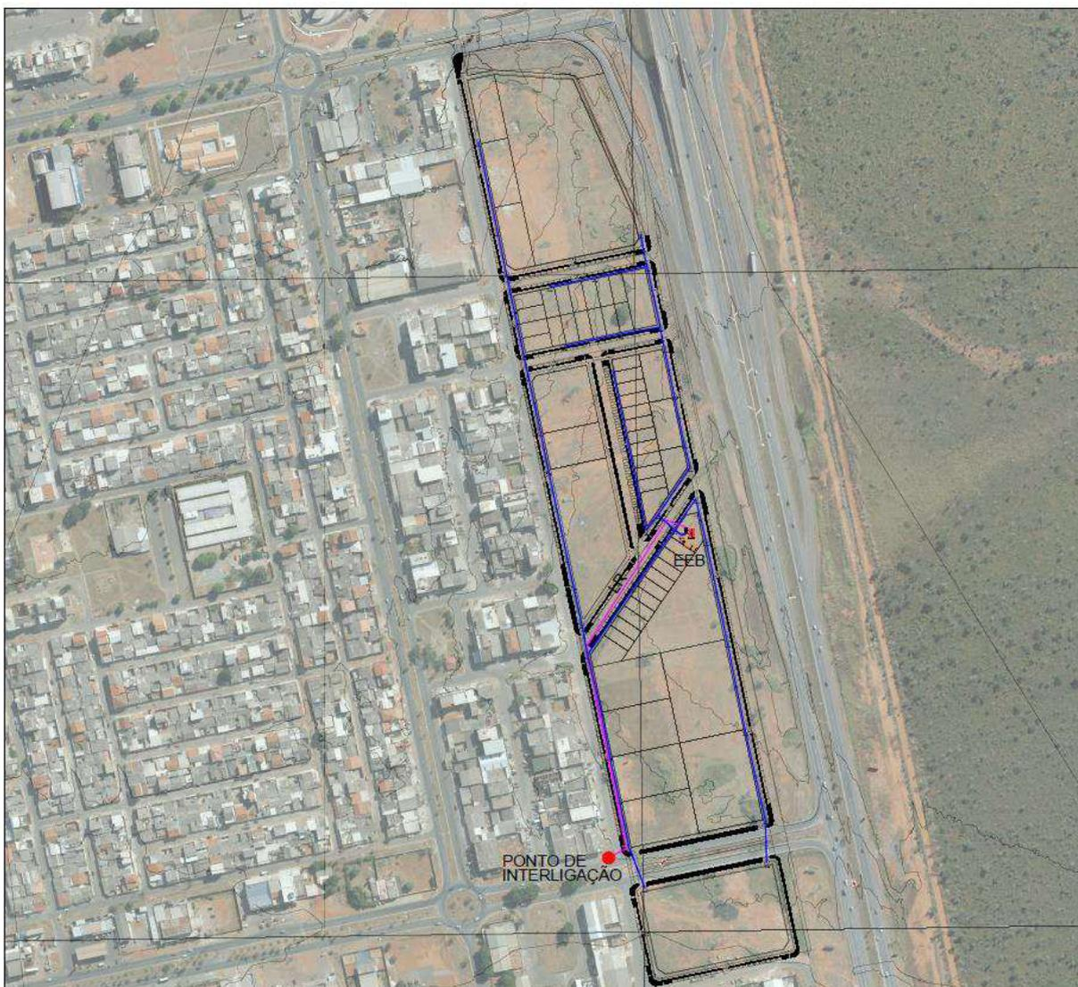
Figura 84: Sistema de Coleta de esgoto do Setor Econômico de Santa Maria
