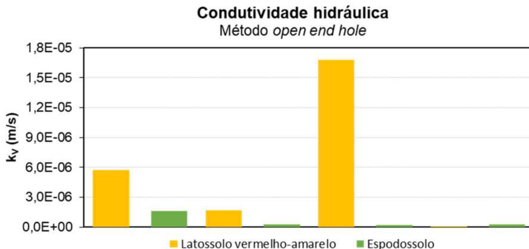
Figura 4: Valores da condutividade hidráulica vertical obtidos a partir do método open end hole .
