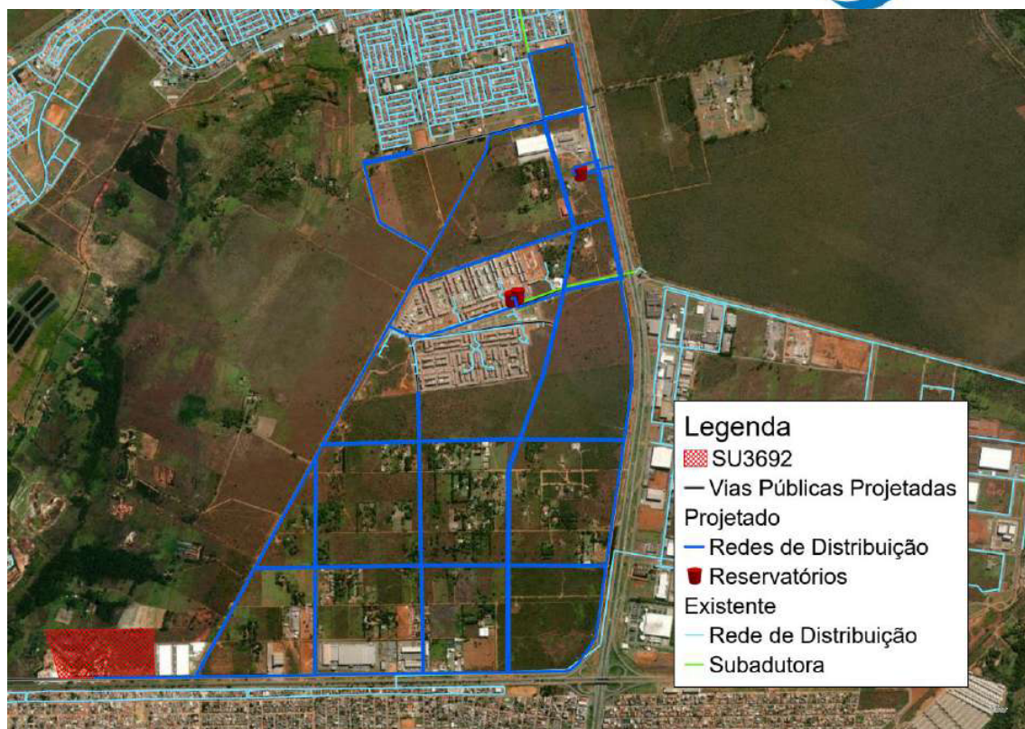
Figura 2. Sistema Projetado de Abastecimento de Água
