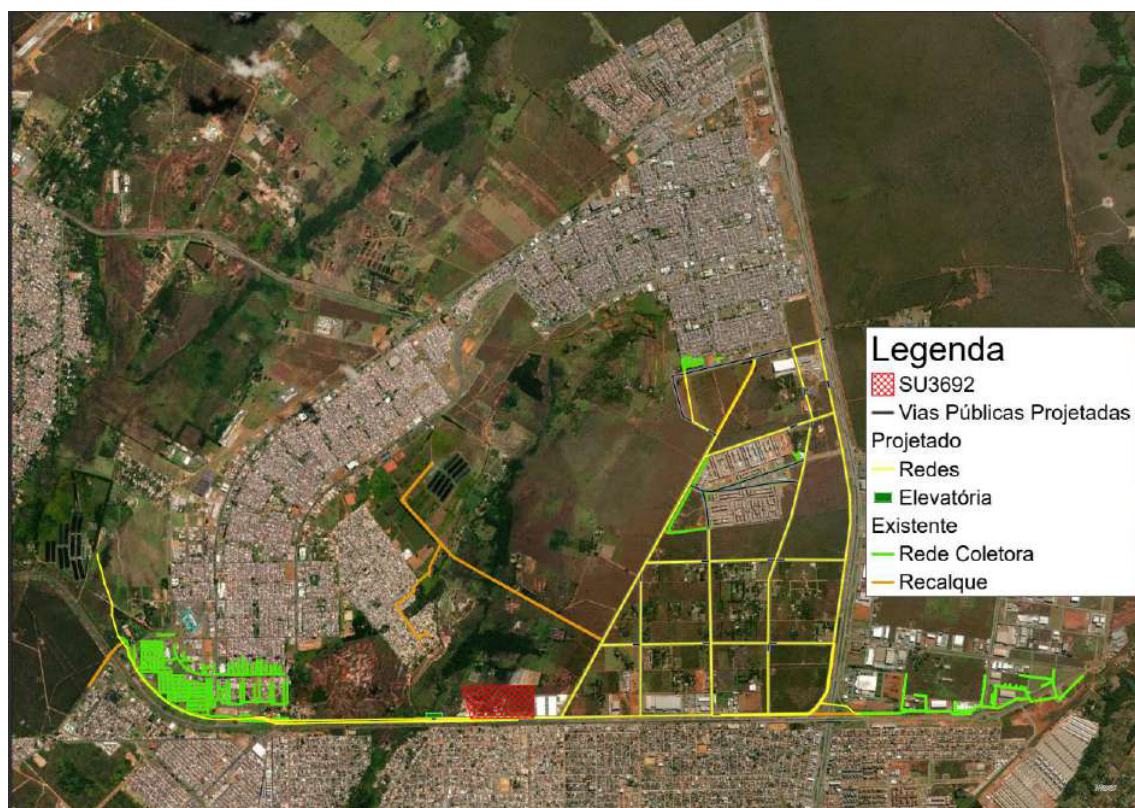
Figura 3. Sistema Projetado de Esgotamento Sanitário
