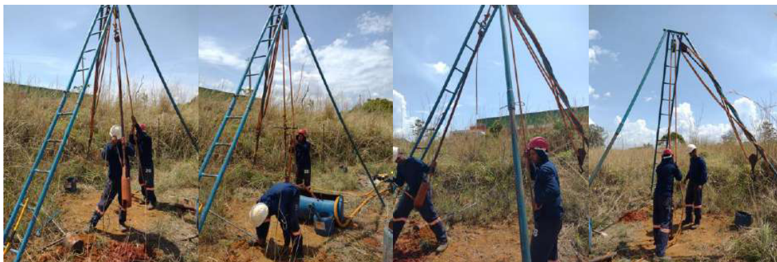
Figura 3: Fotos da realização das sondagens.
