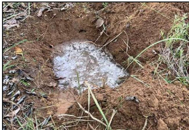
Foto 7. Ensaio de infiltração 2.
