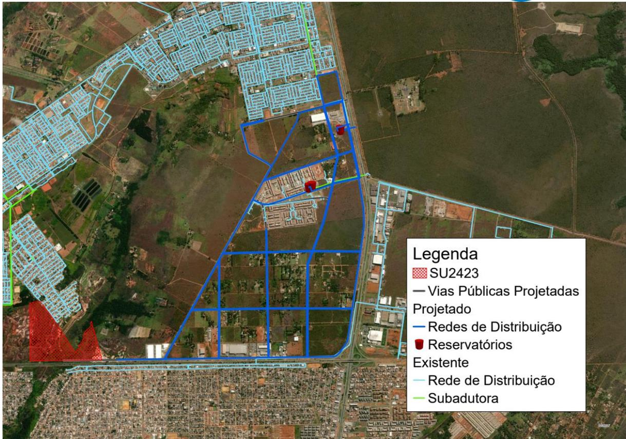
**Figura 2. Sistema Projetado de Abastecimento de Água**
