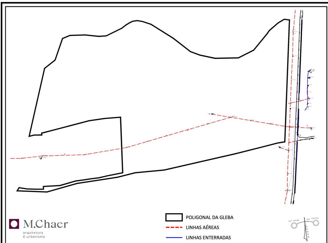
**Figura 05:** Interferência das redes de energia na gleba do parcelamento.
