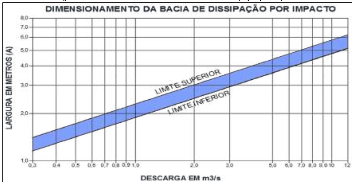
Figura 31 - Ábaco de dimensionamento da bacia de dissipação por impacto
