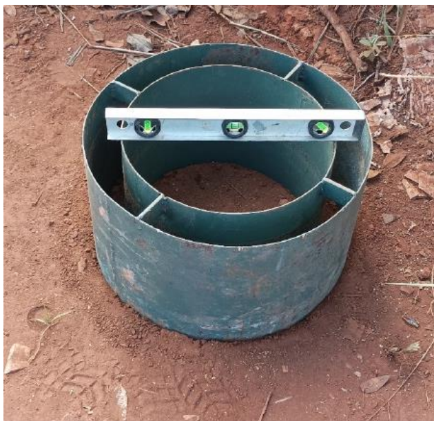
Foto 23 - Nivelamento do equipamento para início do procedimento. Localização: 180.900 E / 8.223.863 S.
