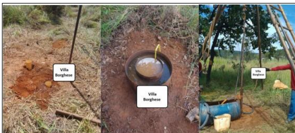
Figura 33: Fotos da execução dos ensaios de Anéis Concêntricos e Open End Hole
