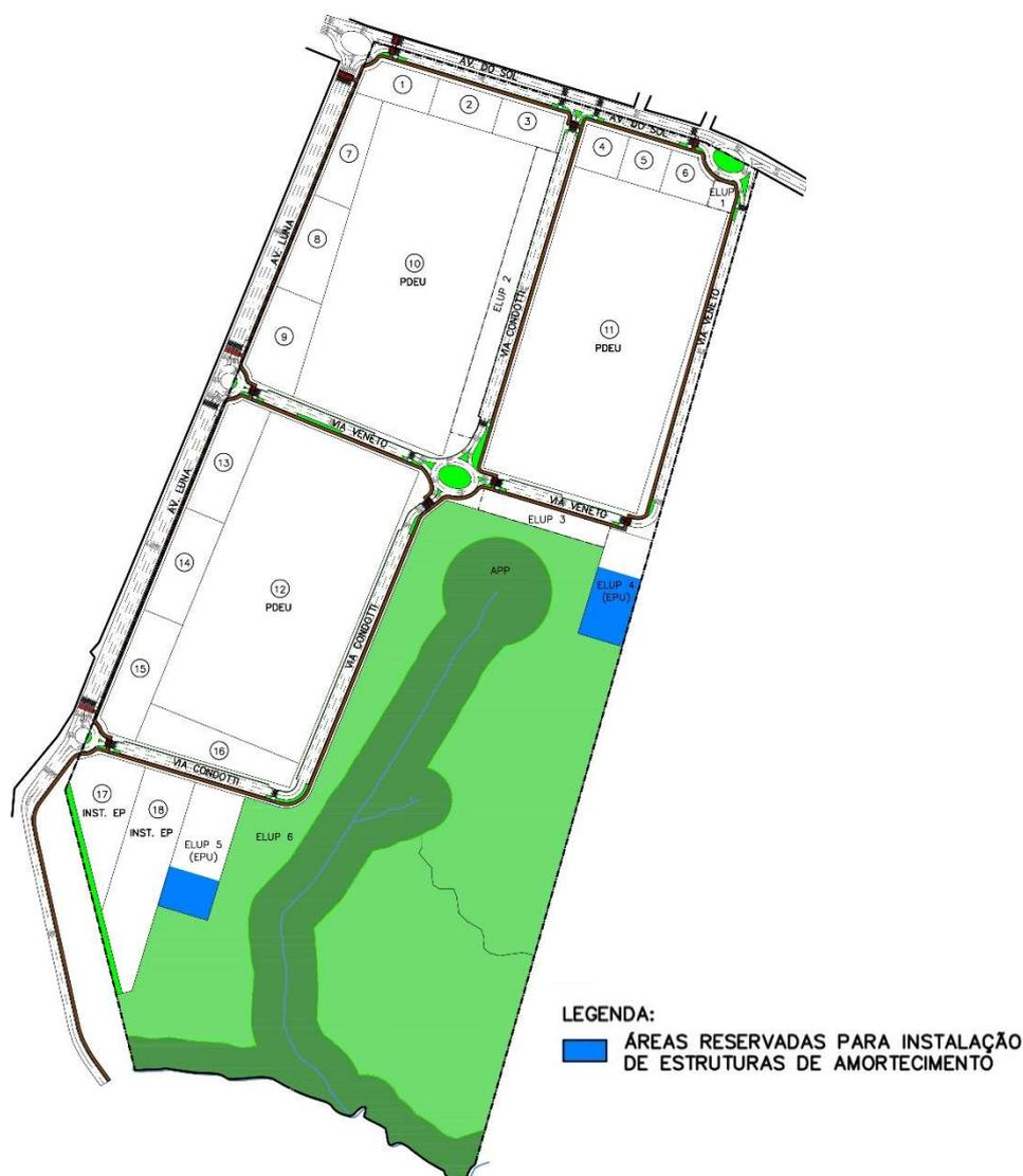
Figura 4: Áreas reservadas para instalação das estruturas de amortecimento.
