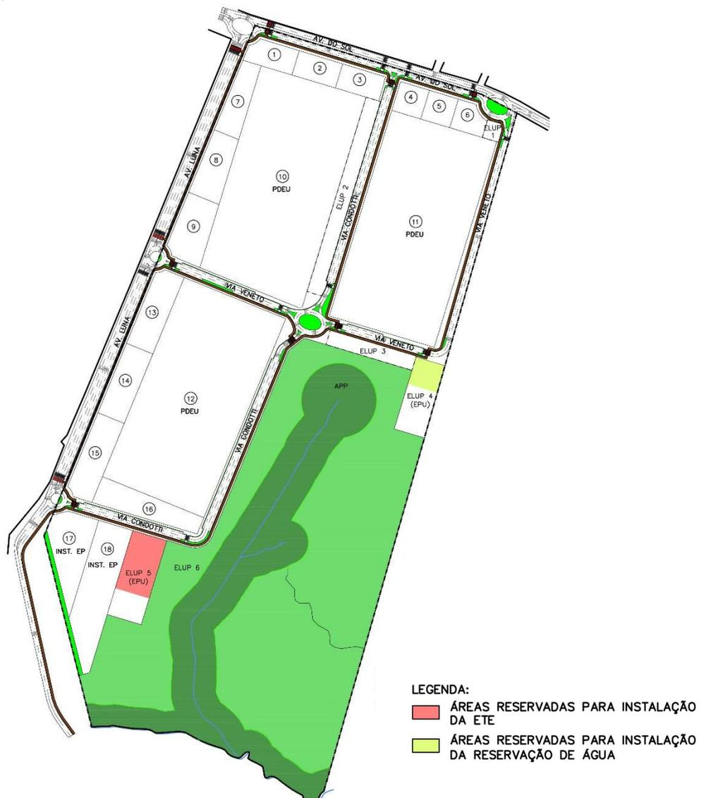
Figura 8: Áreas reservadas para instalação da ETE e reservação de água.
