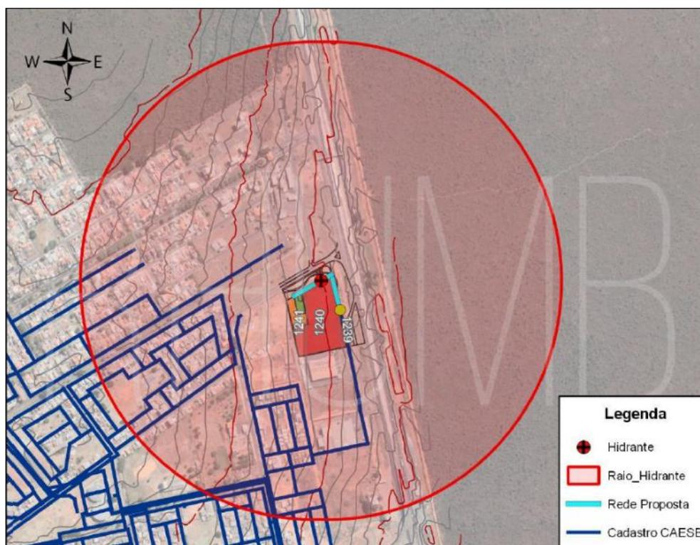
Figura 70 - Posicionamento do hidrante e sua área de abrangência. Fonte: Estudo de Concepção do Sistema de Abastecimento de Água
