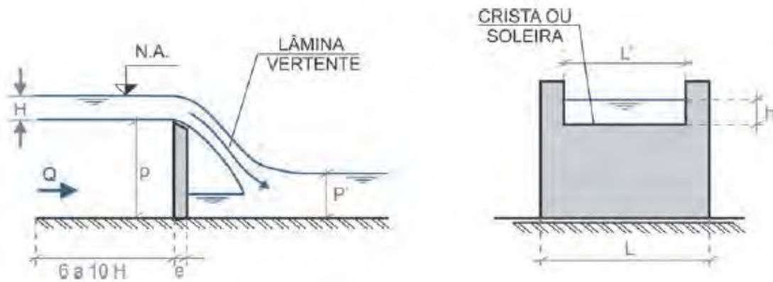
Figura 13 – Vertedor retangular de soleira delgada
