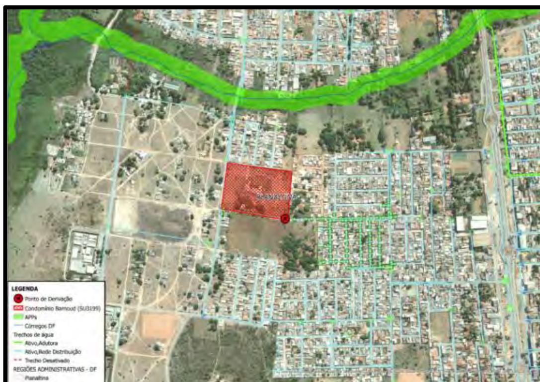
Figura 6 – Ponto de derivação da rede de abastecimento de água para atendimento do empreendimento. FONTE: CAESB
