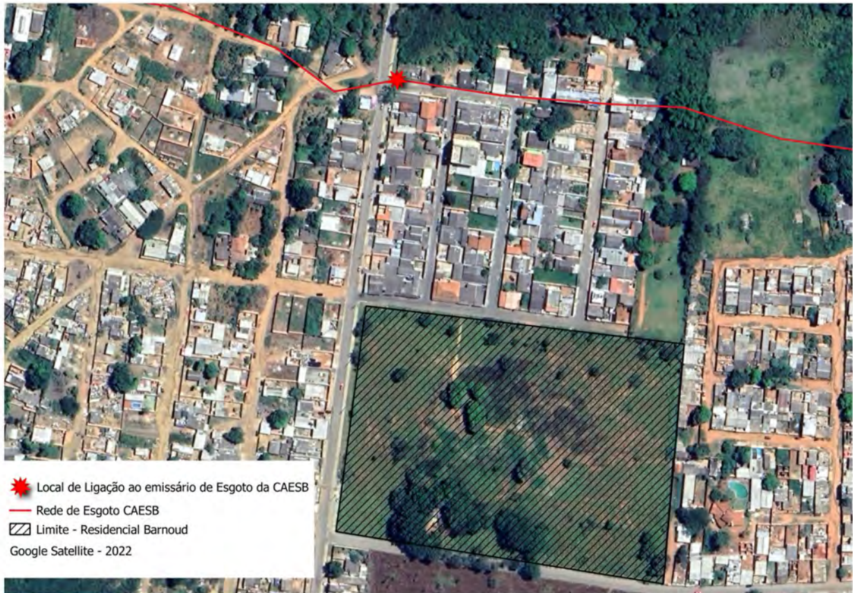
Figura 67 - Localização do ponto de conexão da rede de esgotamento sanitário do parcelamento com o emissário de Esgoto da CAESB. Fonte: CAESB e SISDIA;
