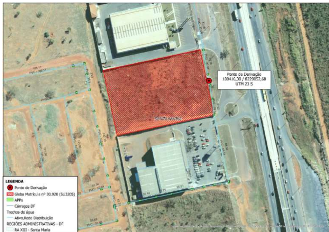
Figura 05: Derivação do ponto de abastecimento de água existente.
