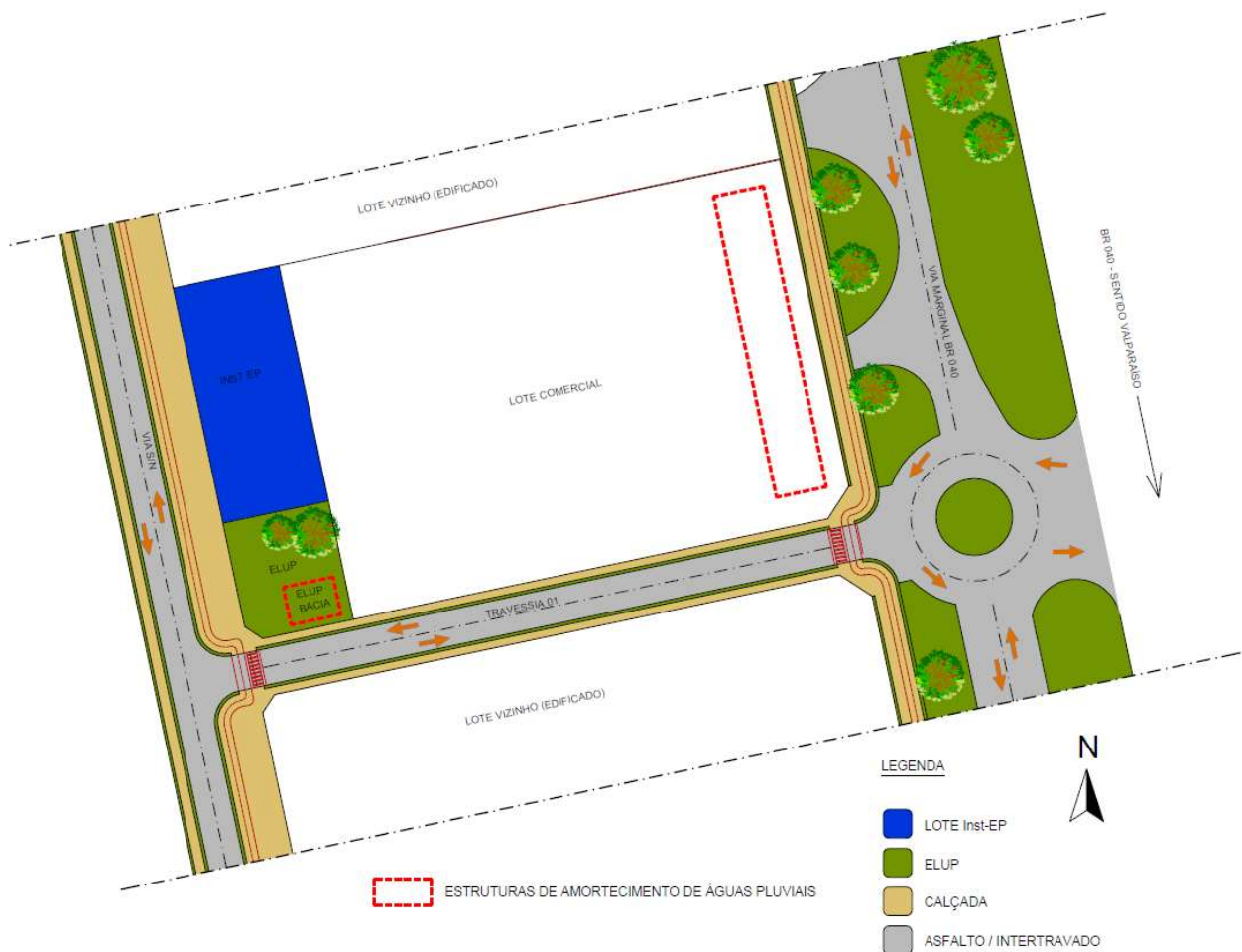
Figura 04: Croqui indicativo da bacia de amortecimento para águas pluviais.
