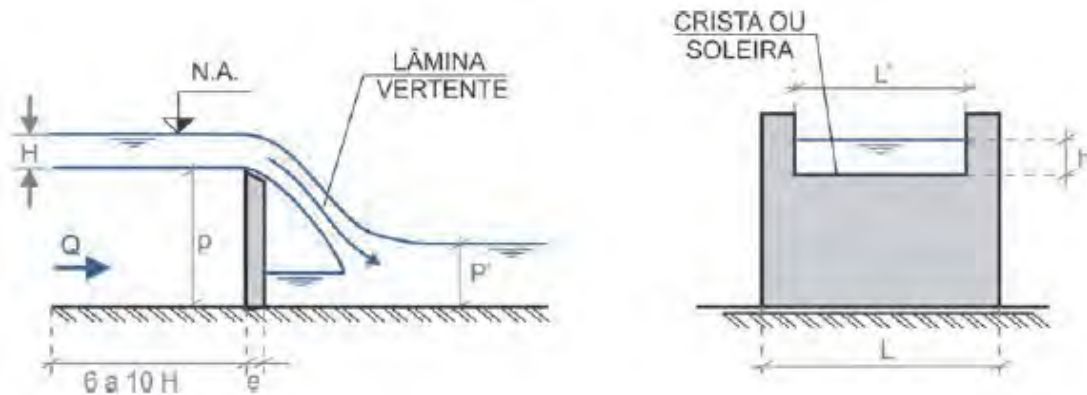
Figura 15 – Vertedor retangular de soleira delgada
