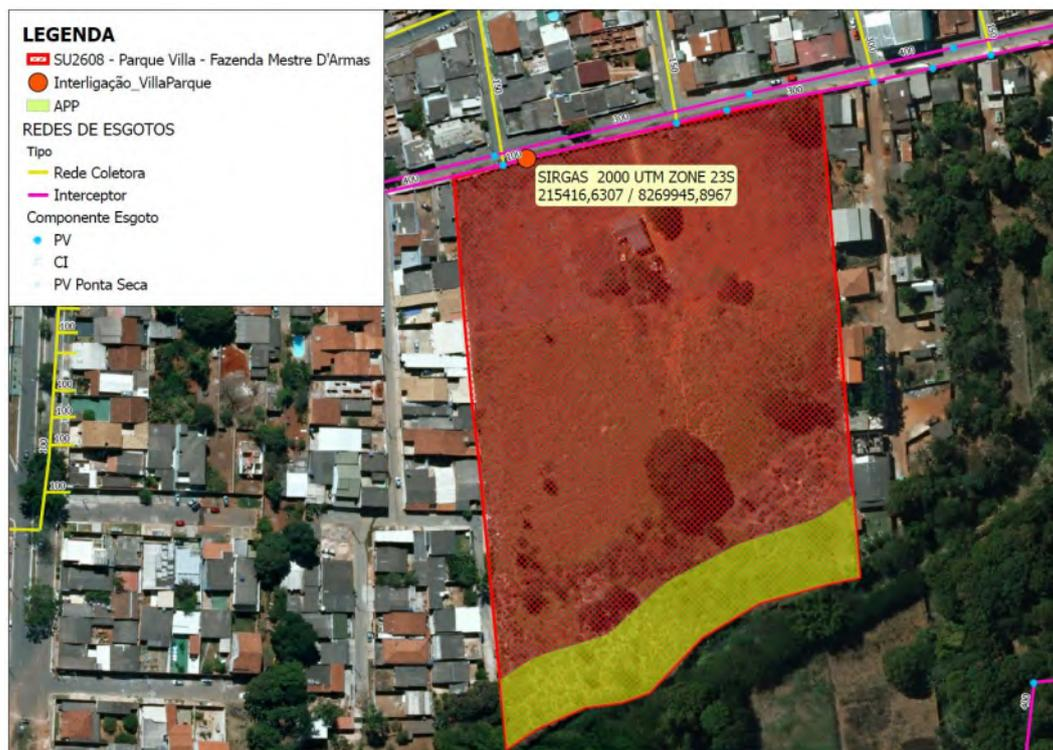
**Figura 3. Ponto de interligação ao sistema de esgotamento sanitário para atendimento do empreendimento: Parque da Villa, Fazenda Mestre D'Armas, Planaltina – RA VI**
