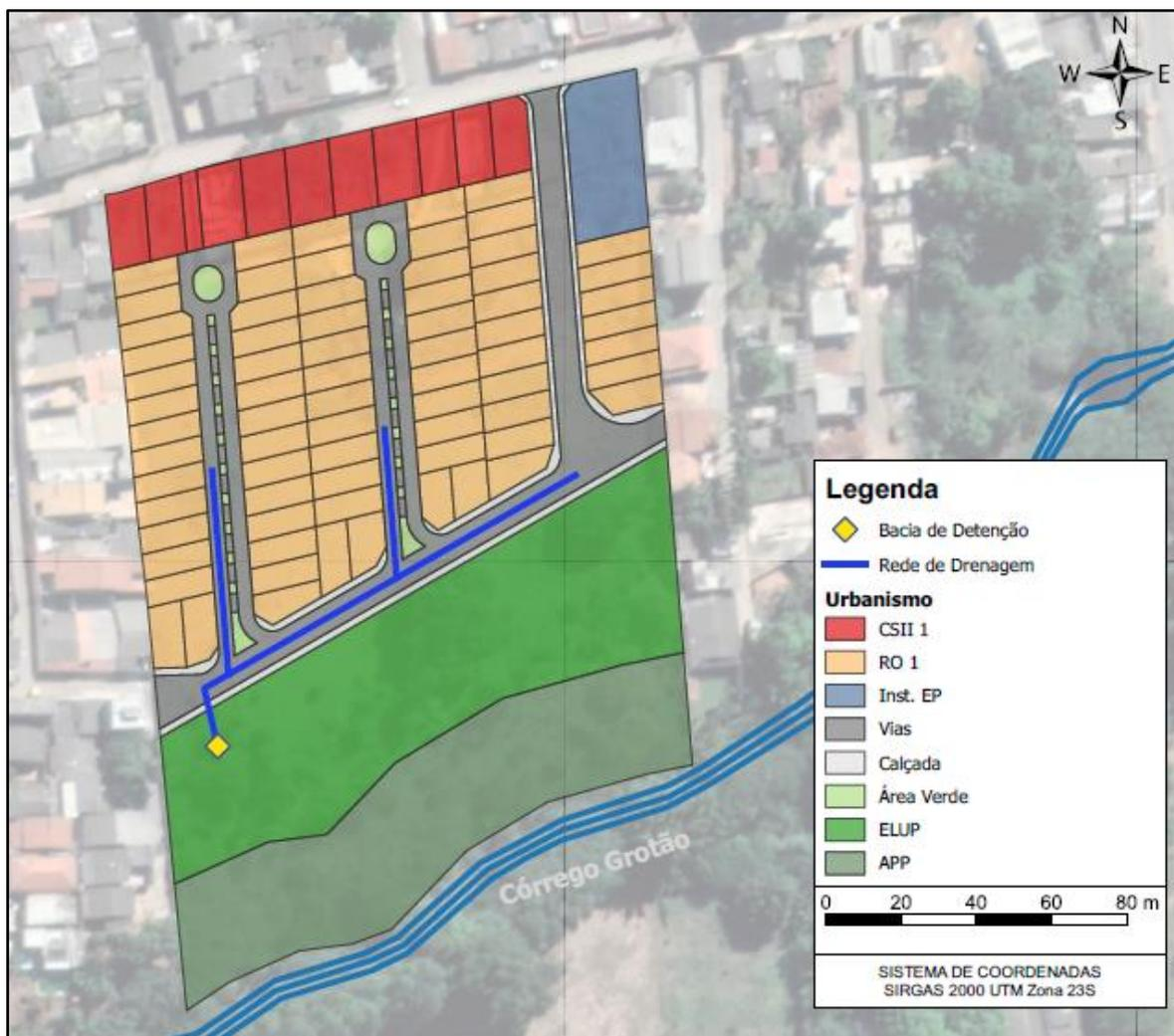
Figura 84. Sistema de drenagem pluvial proposto.
