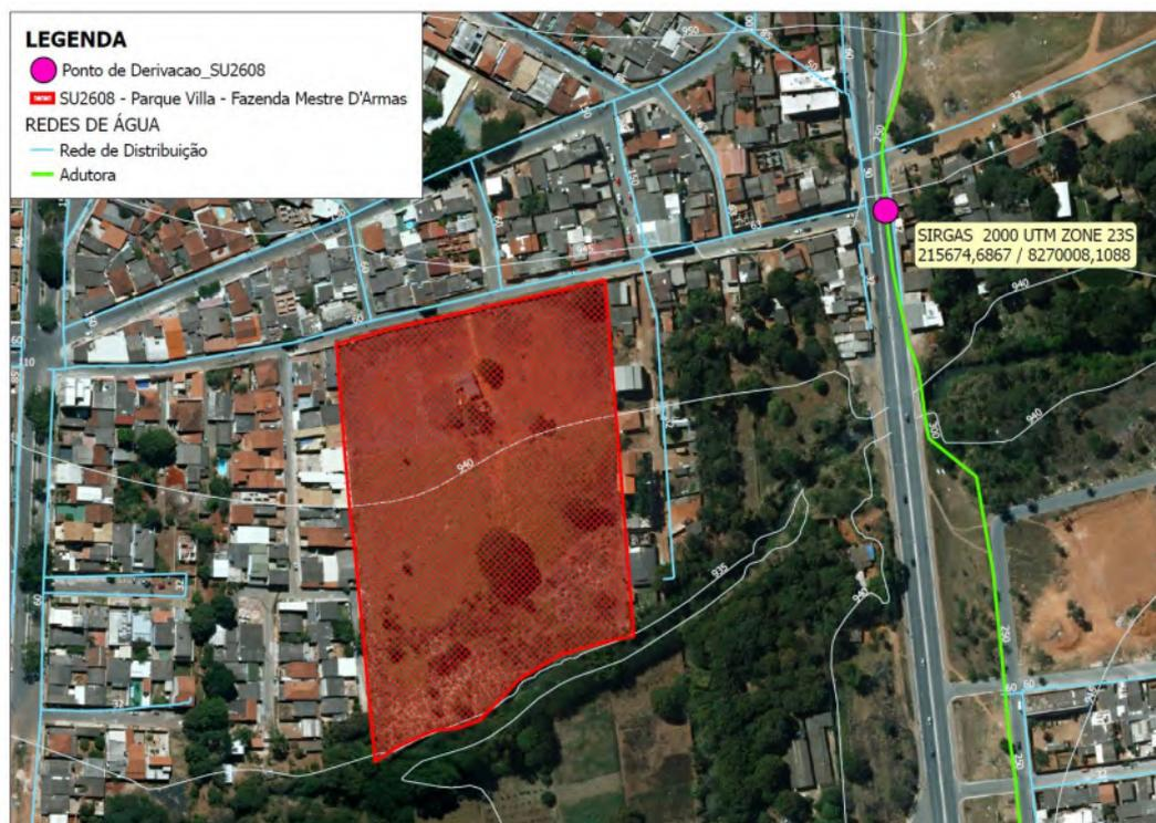
**Figura 2. Ponto de interligação ao sistema de esgotamento sanitário para atendimento do empreendimento: Parque da Villa, Fazenda Mestre D'Armas, Planaltina – RA VI.**
