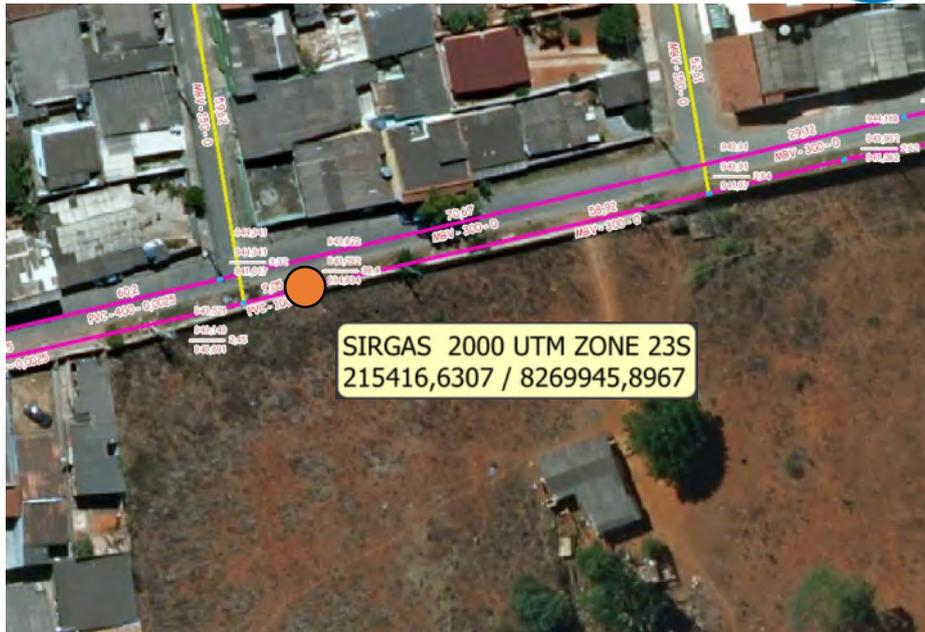
**Figura 4. Indicação de PV para interligação da rede de esgotos.**
