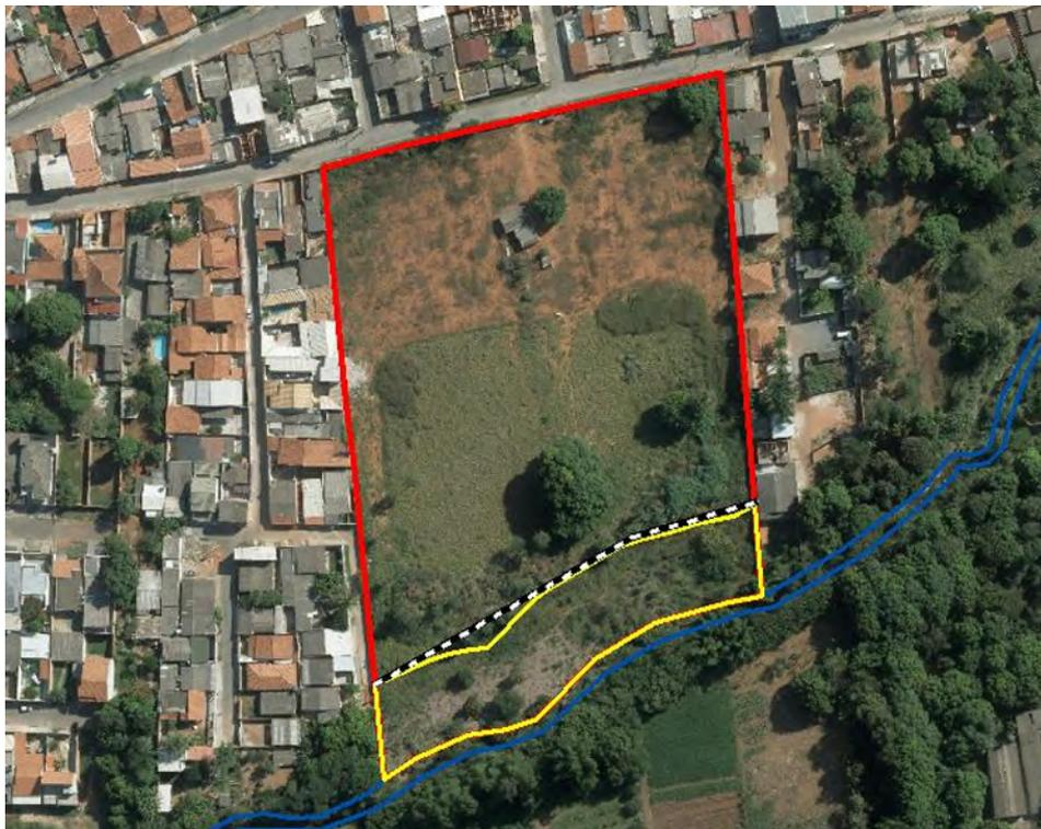
Figura 100. Linha tracejada indicando a localização da cerca que isolará a área de execução do PRADA.
