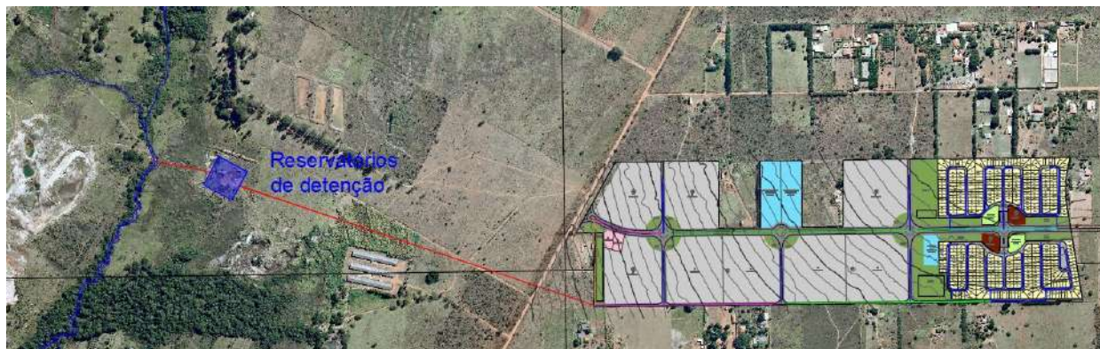
Figura 11.14. Reservatórios de detenção e caminhamento da galeria.
