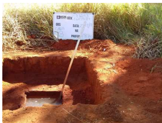
ENSAIO DE INFILTRAÇÃO DO SOLO CAVA 4
