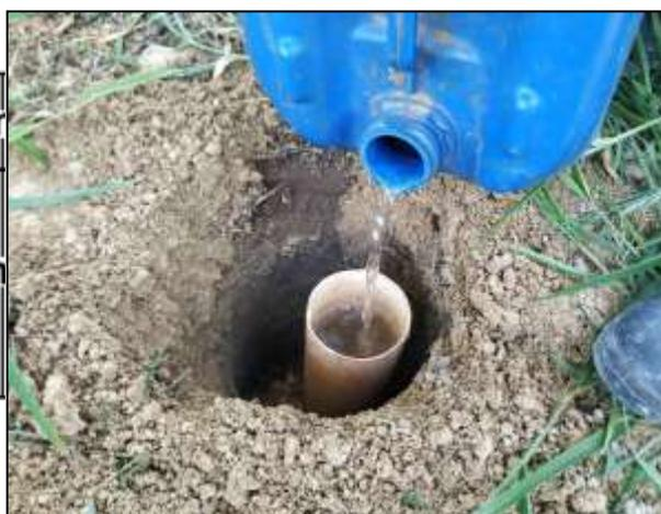
Figura 18 – Esquema dos principais parâmetros do método open end hole para determinação da condutividade hidráulica vertical em subsuperfície.
