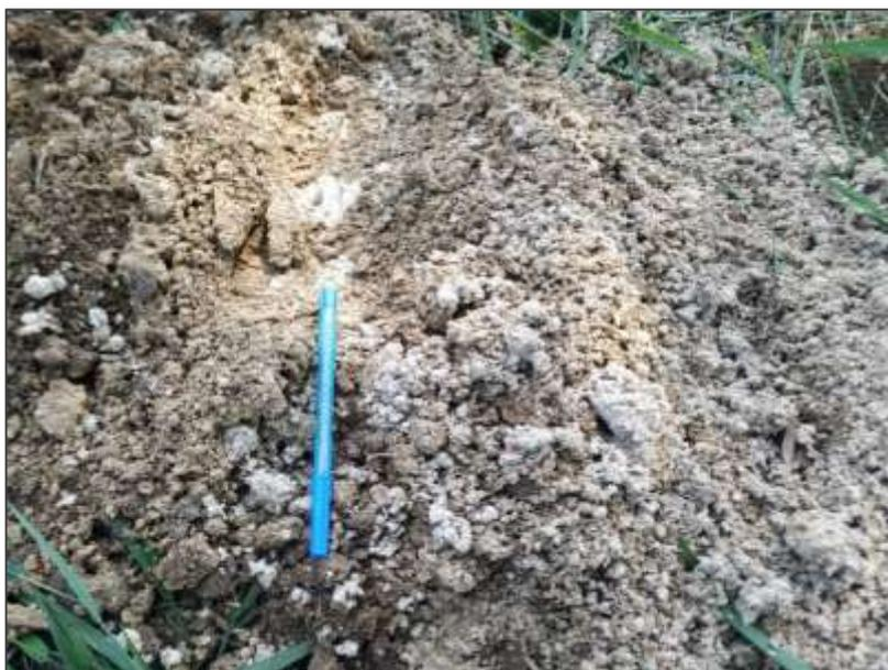
Foto 20 – O gleissolo apresenta coloração mais escura e rica em matéria orgânica nos centímetros iniciais (esquerda). Em maiores profundidades, a coloração é esbranquiçada e o solo, muito plástico (direita). Localização: 202.173 E / 8.242.048 N, 23L.
