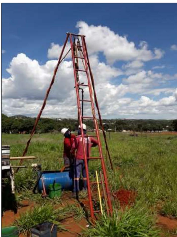
Foto 24 – Ensaio de sondagem SPT na ADA. Localização: 202.033 E / 8.241.585 N, 23L
