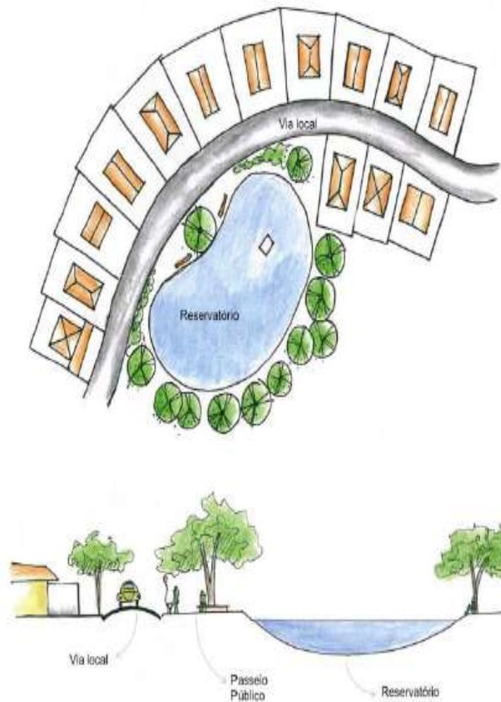
Figura 36 - Implantação de estrutura de armazenamento em área urbana. Fonte: CODAU, 2009.
