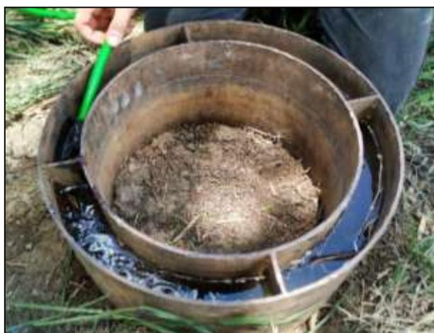
Foto 22 – Preenchimento do anel externo para garantir a infiltração vertical da água posteriormente adicionada ao anel interno. Localização: 202.171 E / 8.242.054 N, 23L.
