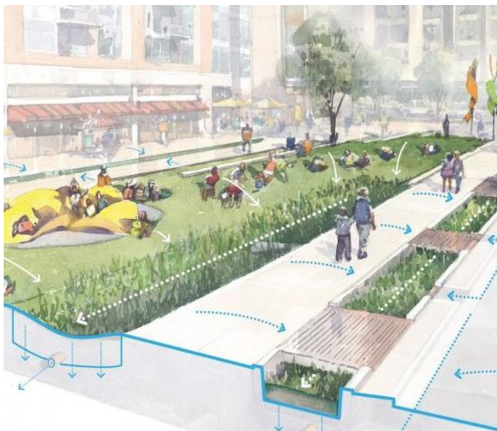
Figura 19 – Canteiro Central com sistema de biorretenção
