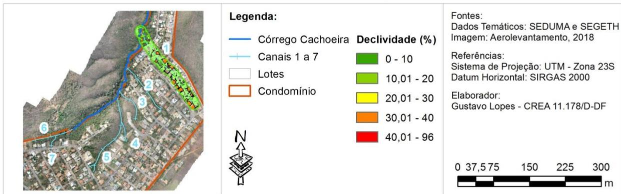
Figura 12. Mapa de declividade elaborado a partir do levantamento topográfico do Condomínio Privê Morada Sul – Etapa A.
