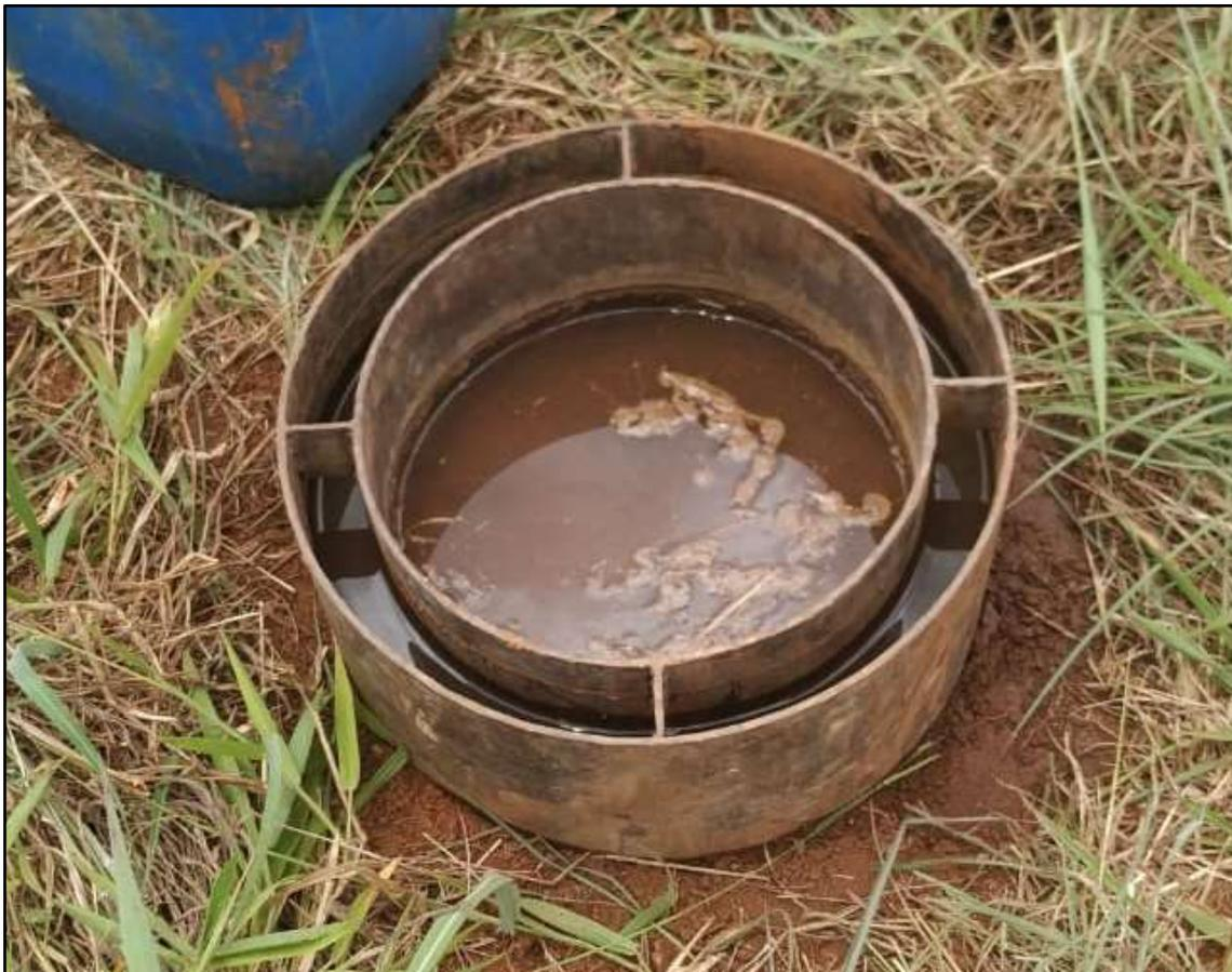
Foto 5: Rebaixamento do nível da água no cilindro interno.
