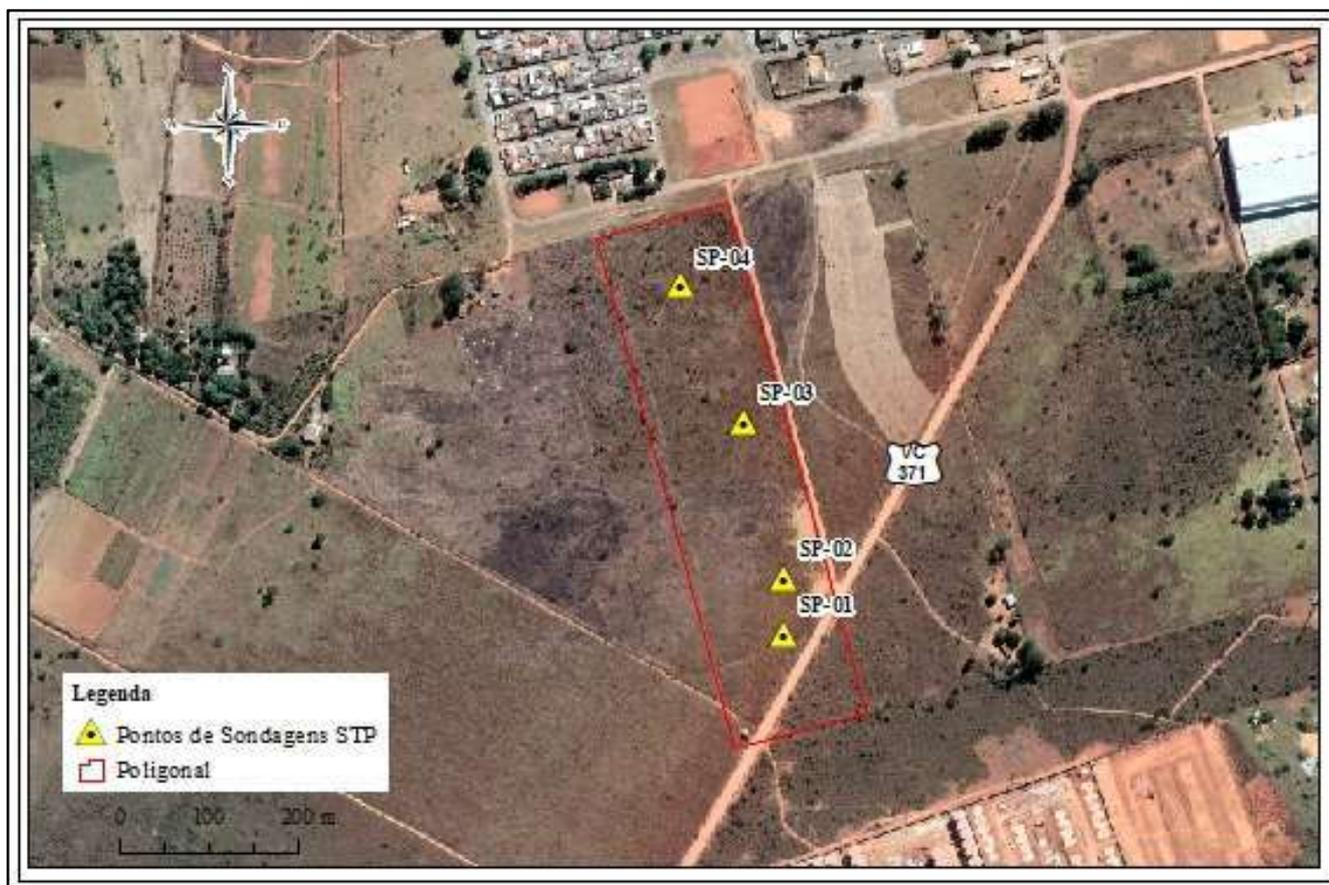
Figura 2: Localização dos pontos de sondagem SPT.
