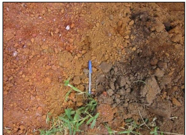
Foto 4 – Variação do Cambissolo extraído de um furo de 1.5 m de profundidade. O solo escuro, à direita, corresponde ao topo do perfil e o solo vermelho-amarelo, à esquerda, à sua base.
