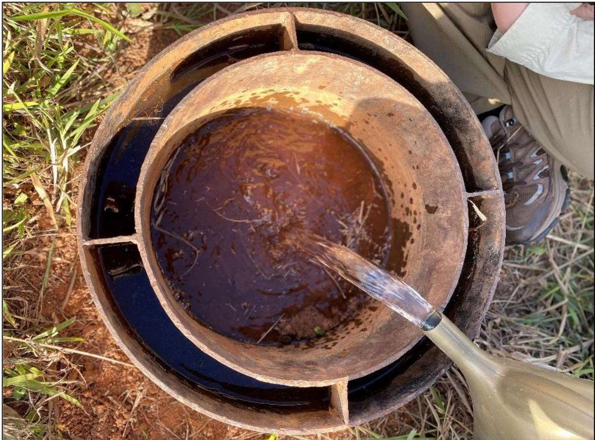
Foto 14 – Preenchimento do cilindro interno com água. Localização: 200.693 E / 8.234.029 N, Zona 23L.
