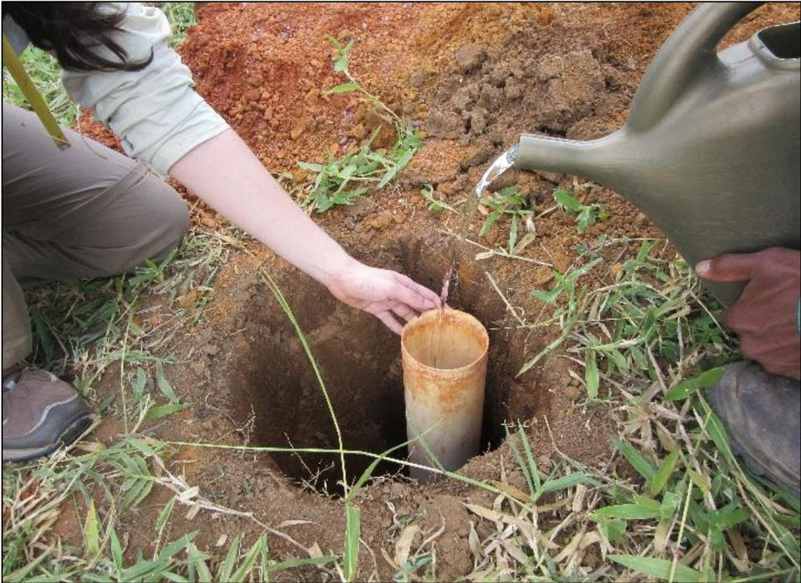
Foto 15 – Preenchimento do cano PVC com água para posterior medição do nível de rebaixamento. Localização: 200.790 E / 8.234.028 N, Zona 23L.
