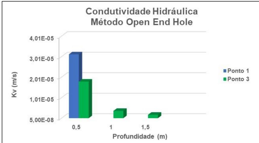
Figura 9 – Valores de condutividade hidráulica vertical para o Cambissolo (Ponto 1) e associação de Gleissolo e Organossolo (Ponto 3), obtidos no ensaio com o método *open end hole*.
