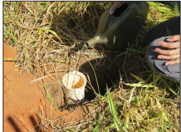
Foto 7 – Tubo de PVC cravado no solo sendo preenchido por água.
