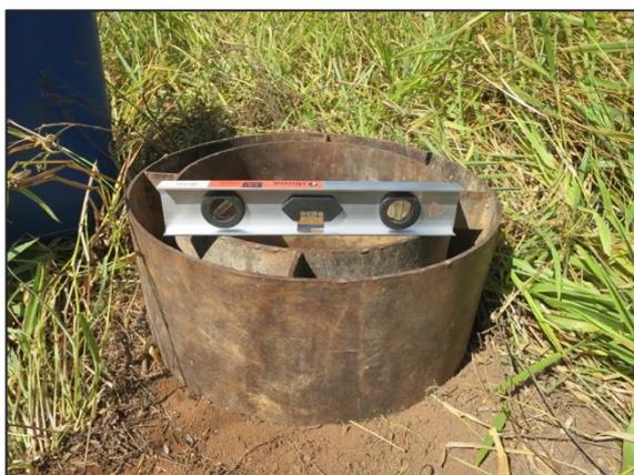
Foto 4 – Nivelamento dos anéis concêntricos. Localização: 200.388 E / 8.233.550 N. Crédito – GEO LÓGICA.
