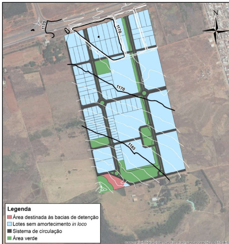
Figura 21: Alternativa 2 para o sistema de drenagem pluvial do Complexo IKEDA.
