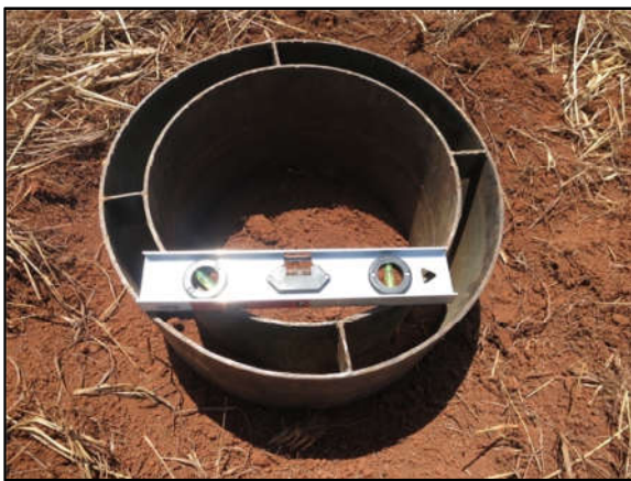
Foto 4: Nivelamento dos anéis concêntricos. Localização: 803.137 E /8.251.429 N, Zona 22L.
