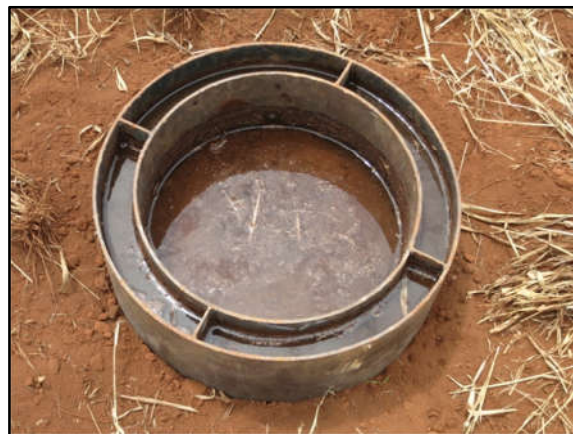
Foto 6: Rebaixamento do nível da água no cilindro interno. Nível externo sempre acima do nível interno. Localização: 803.137 E /8.251.429 N, Zona 22L.
