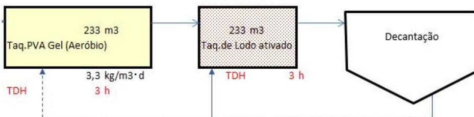
Figura 1.17: Sistema com uso de PVA Gel
