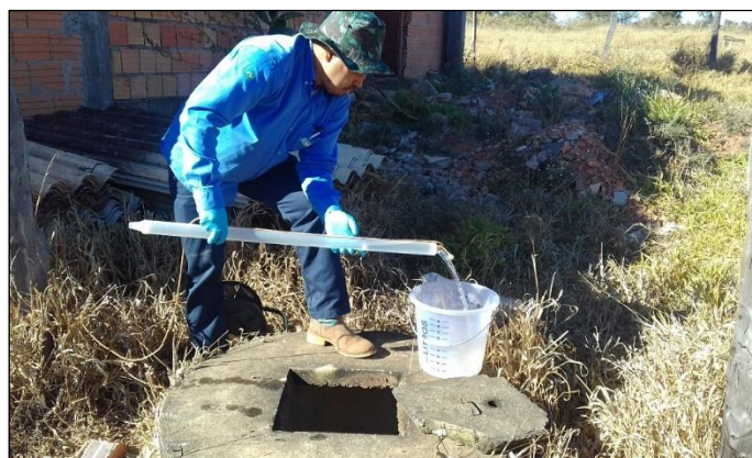
Foto 2.12: Amostragem de água subterrânea na área do empreendimento. Amostragem realizada em julho de 2017. Ponto RIAC P 01. Fotografia: UPSA
