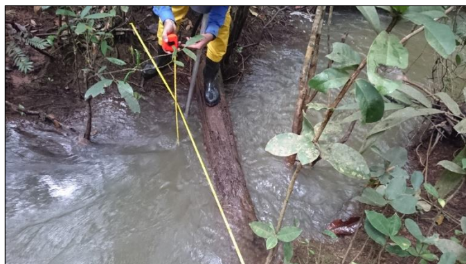
Foto 2.5 - Aspecto do ponto e procedimento de medição para coleta de água superficial. Amostragem realizada em março de 2017. Ponto RIAC P 06. Fotografia: UPSA
