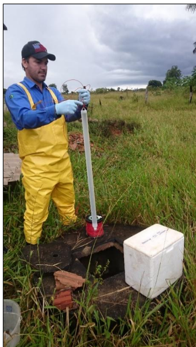
Foto 2.11: Amostragem de água subterrânea na área do empreendimento. Amostragem realizada em março de 2017. Ponto RIAC P 01. Fotografia: UPSA.
