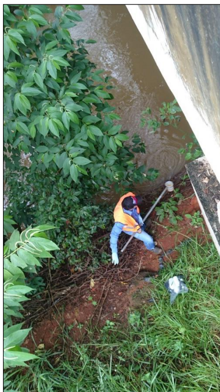
Foto 2.6 - Aspecto do ponto e procedimento de coleta de água superficial. Amostragem realizada em março de 2017. Ponto RIAC P 05. Fotografia: UPSA
