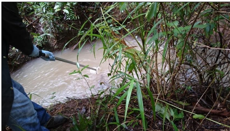
Foto 2.7 – Aspecto do ponto e procedimento de coleta de água superficial. Amostragem realizada em março de 2017. Ponto RIAC P 06. Fotografia: UPSA.
