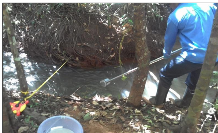
Foto 2.8 - Aspecto do ponto e procedimento de coleta de água superficial. Amostragem realizada em março de 2017. Ponto RIAC P 06. Fotografia: UPSA.
